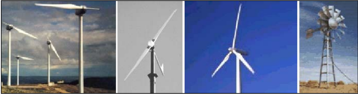
Figura 19: Turbinas eólicas com rotores de eixo horizontal
