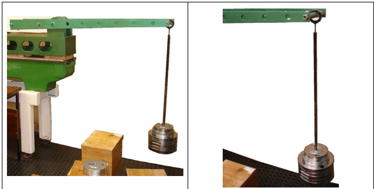
Figura 34: Calibração do padrão de torque.
