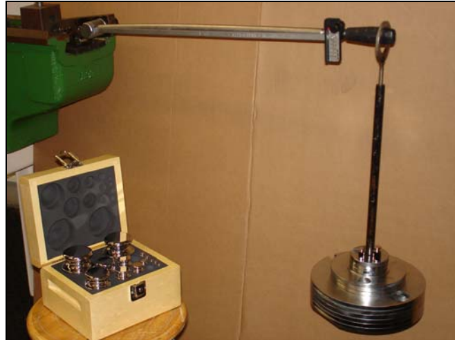
Figura 14: Calibração de torquímetro pelo sistema direto.
