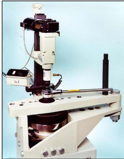
Figura 16: Detalhe de estrutura da mesa de calibração (AKOTORQUE, 2006).
