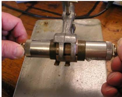
Figura 3.9: Fixação e medição da velocidade de pulso.
