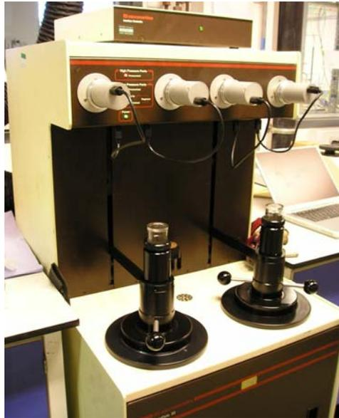
Figura 3.2: Porosímetro por intrusão de mercúrio
