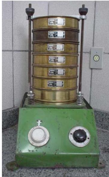
Figura 3.12: Peneirador mecânico com série de peneiras ABNT.
