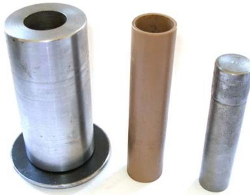
Figura 3.14: Matriz, molde polimérico e punção de prensagem.
