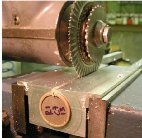
Figura 3.16: Desmoldagem dos corpos de prova
