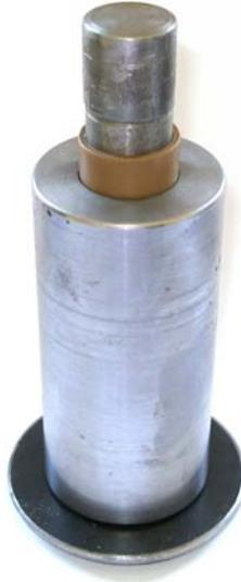
Figura 3.15: Montagem da matriz de fabricação.
