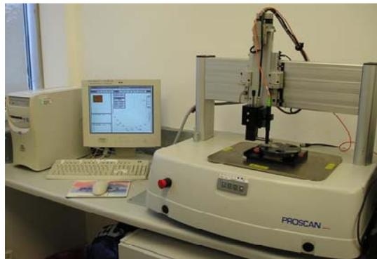
Figura 3.10: Perfilômetro Óptico para medição de rugosidade superficial
