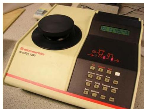
Figura 3.13: Pycnômetro a gás
