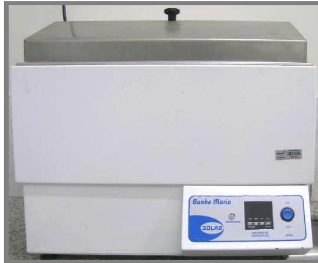
FIGURA 6. Termopolimerizadora automática Solab.
