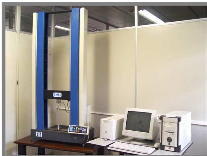
FIGURA 11. Máquina para ensaio mecânico EMIC modelo DL 3000.
