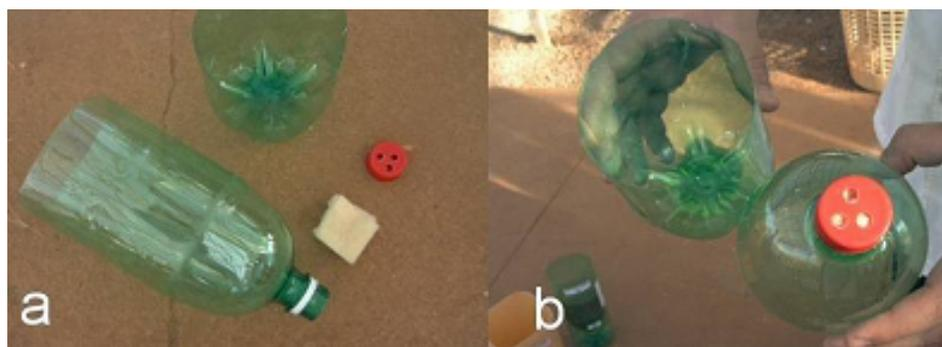
FIGURA 1 Vasos confeccionados de garrafas de polietileno tereftalato (PET) com 2 dm<sup>3</sup> de capacidade volumétrica, (a) garrafa cortada aproximadamente ao meio, com a tampa perfurada e lã de vidro, (b) coletor e o vaso montado contendo a tampa furada e a lã de vidro.
