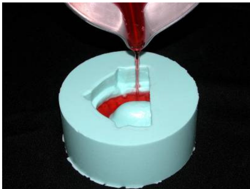
FIGURA 8 – Cera liquefeita vazada no molde.
