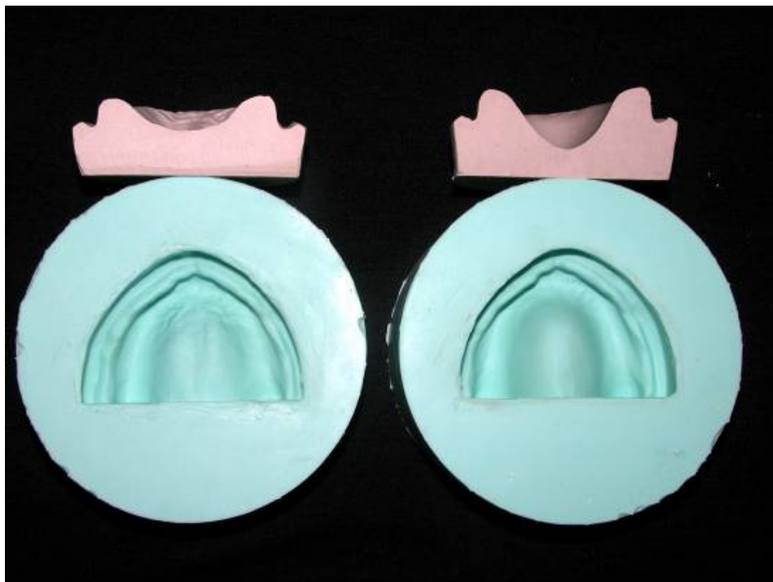
FIGURA 5 – Caixa-molde em silicone para duplicação dos modelos utilizados no experimento.
