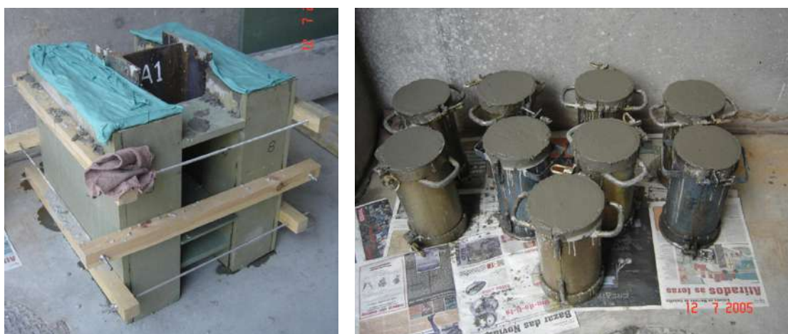
FIGURA 3.54 – Modelos X1 e X2 no LEST/UM – umidificação do concreto e amostras para caracterização.
