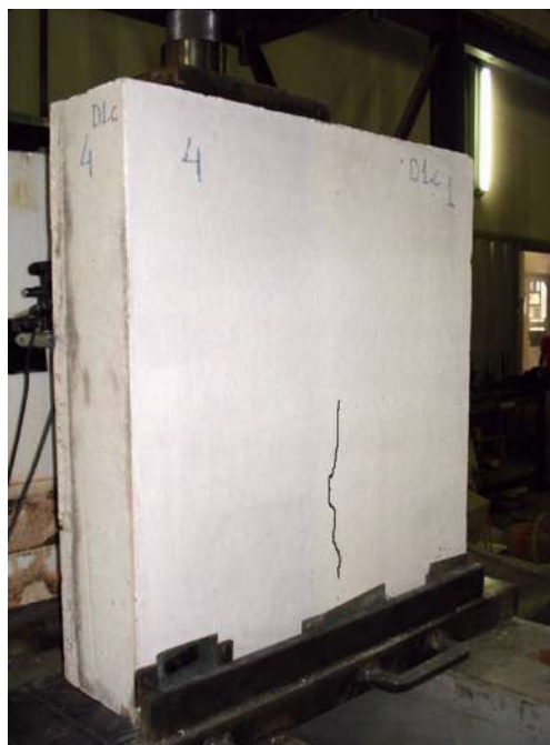
FIGURA 3.102 – (a) distribuição de tensões de tração abaixo dos conectores (MEDBERRY e SHAROOZ, 2002); (b) aspecto típico da primeira fissura que surge nos ensaios com conectores CR56b-PL.
