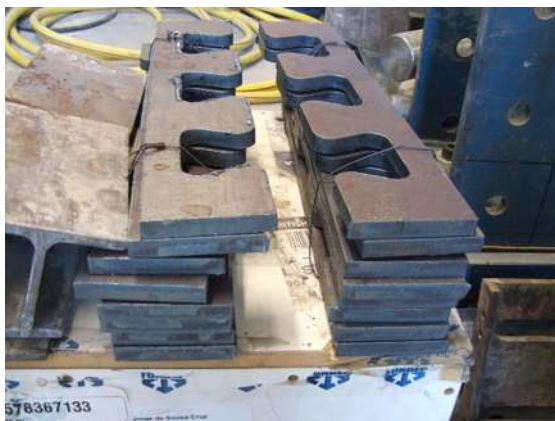
conectores CR56b cortados a oxicorte em Portugal
