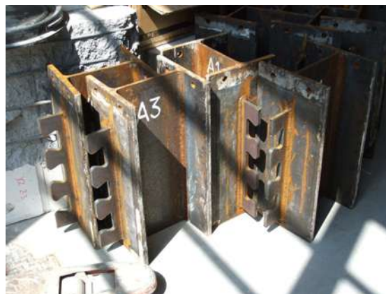
conectores CR56b montados nos perfis para a série B
