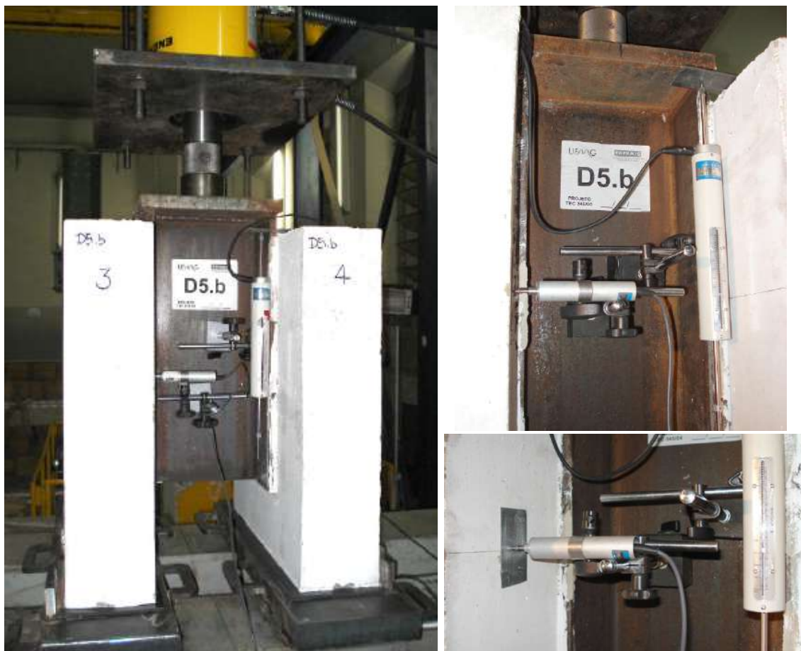
FIGURA 3.99 – Posicionamento dos transdutores de deslocamento.
