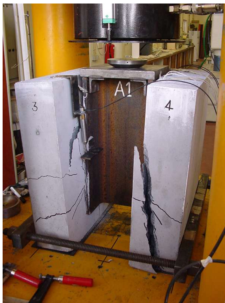
FIGURA 3.26 – Sistema de contenção lateral usado no ensaio A1.
