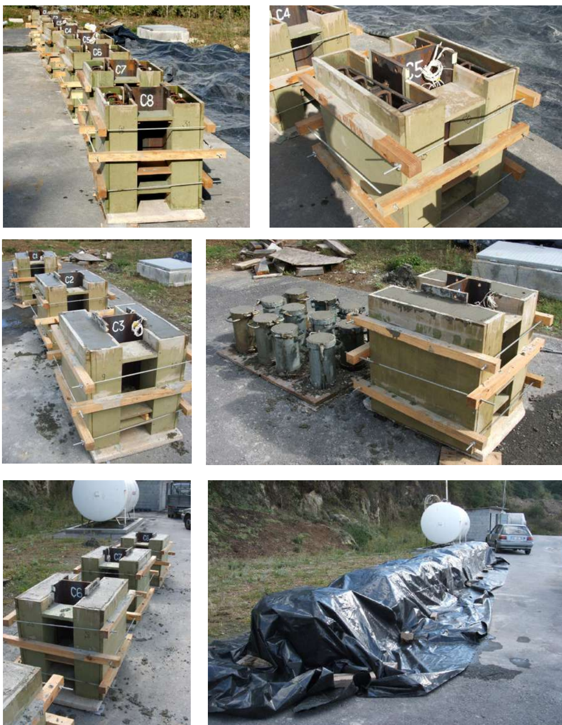
FIGURA 3.68 – Concretagem dos modelos da série C.
