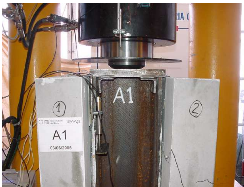
FIGURA 3.29 – Ensaio com o modelo A1 – deslizamento superior a 60 mm.
