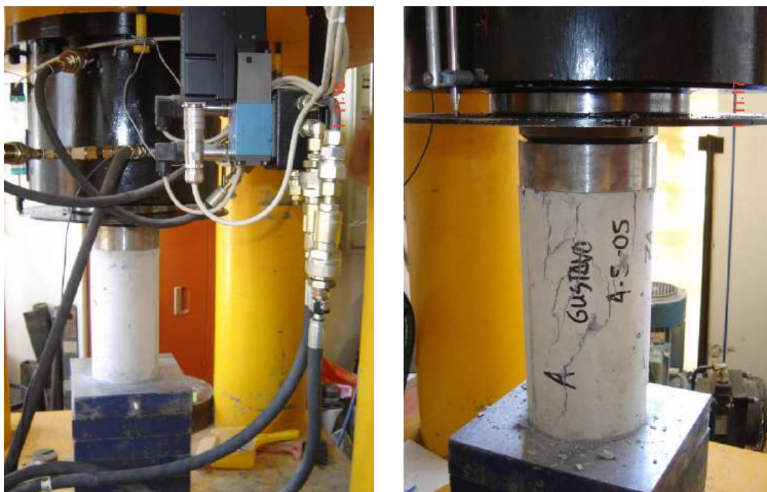
FIGURA 3.39 – Ensaio para determinação da resistência à compressão do concreto.
