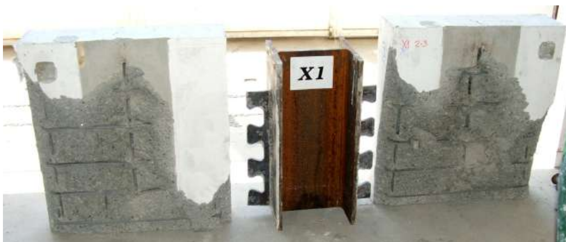
FIGURA 3.59 – Aspecto do modelo X1 com conector CR56b após o ensaio de teste.
