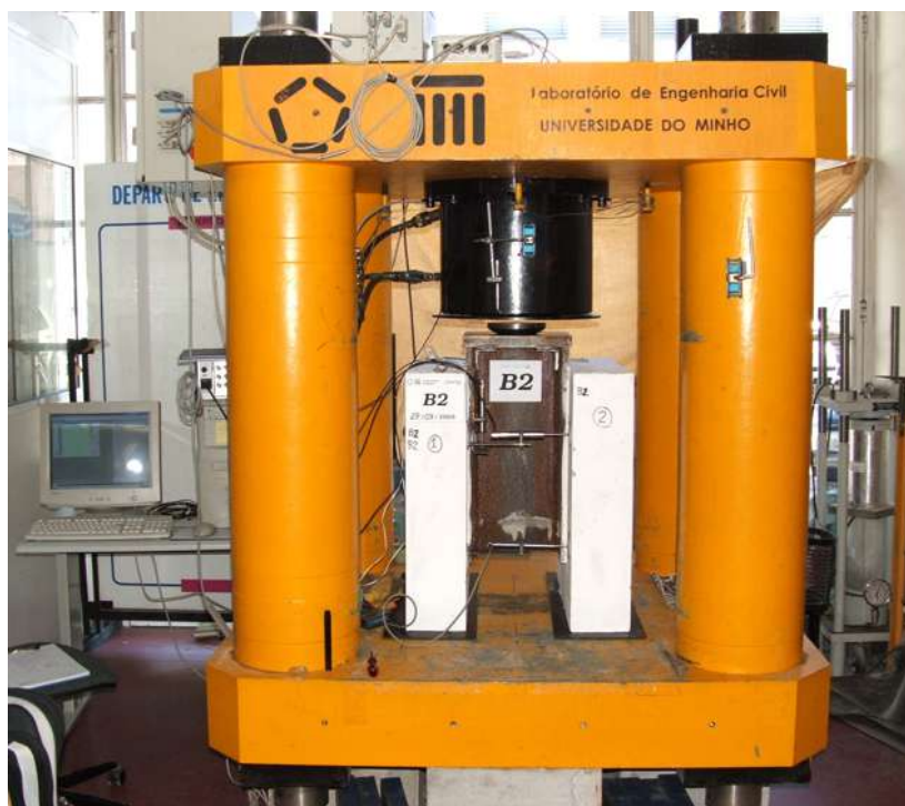
FIGURA 3.25 – Estrutura de reação e equipamento para o ensaio push-out .
