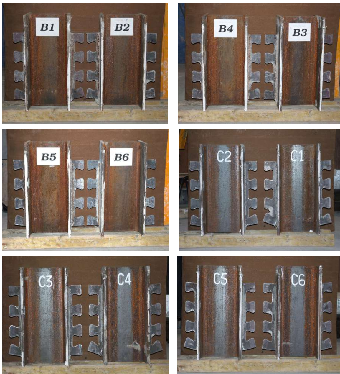
FIGURA 3.69 – Aspecto dos conectores das séries B e C após os ensaios.
