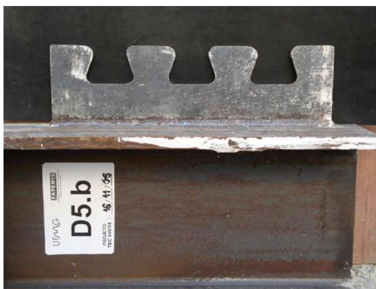
FIGURA 3.112 – Conector intacto após ensaios da série D.
