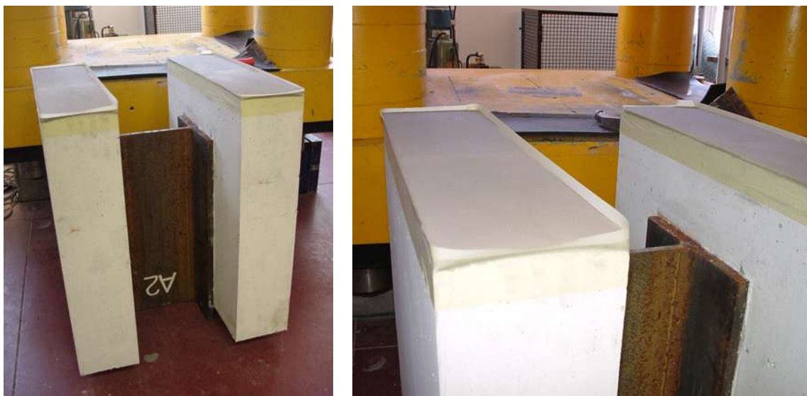
FIGURA 3.24 – Regularização das lajes com argamassa auto-nivelante.
