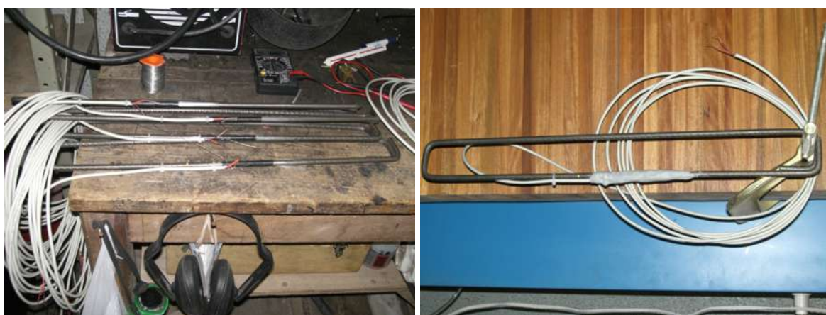
FIGURA 3.82 – Aplicação de extensômetros elétricos às barras da armadura para os modelos push-out da série D.
