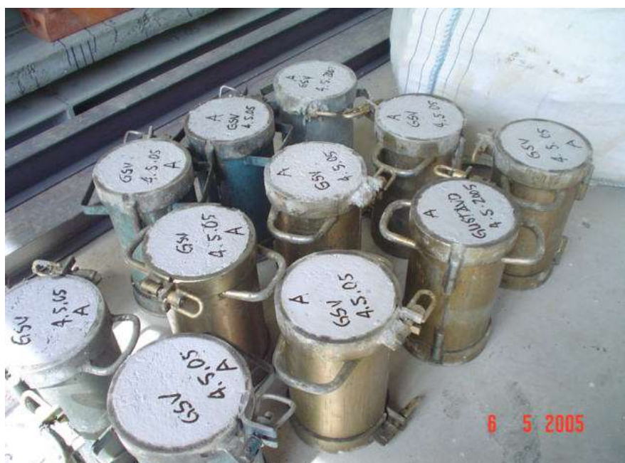
FIGURA 3.38 – Corpos-de-prova cilíndricos para caracterização do concreto.
