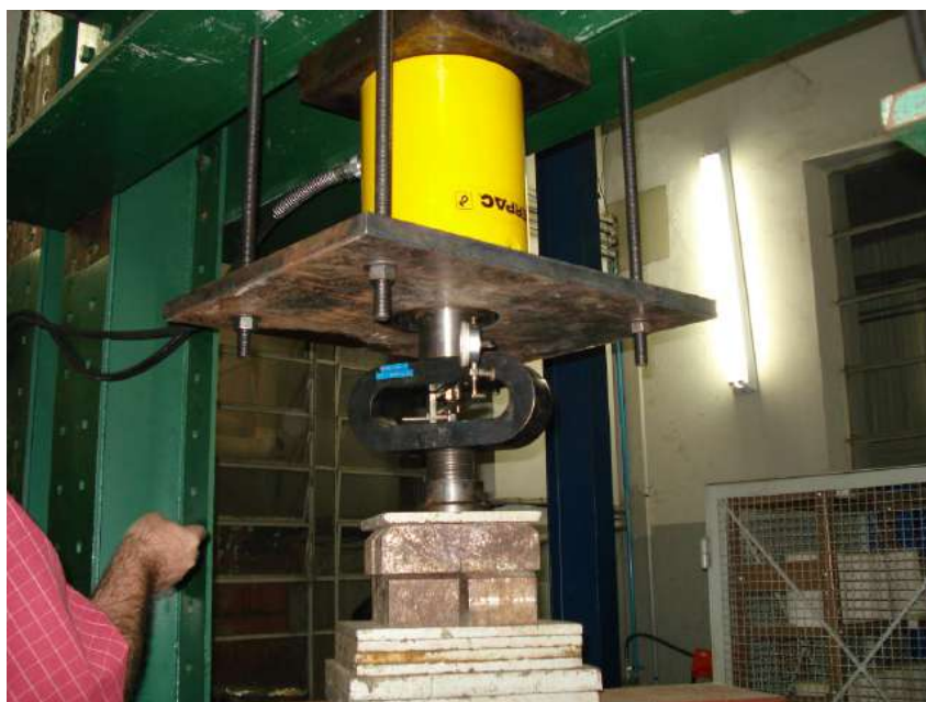
FIGURA 3.98 – Calibração do atuador hidráulico.
