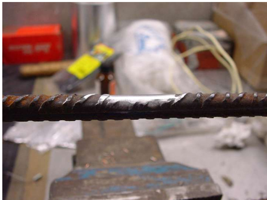
FIGURA 3.16 – Aspecto da barra de aço após desbaste das mossas aplicação da lixa.
