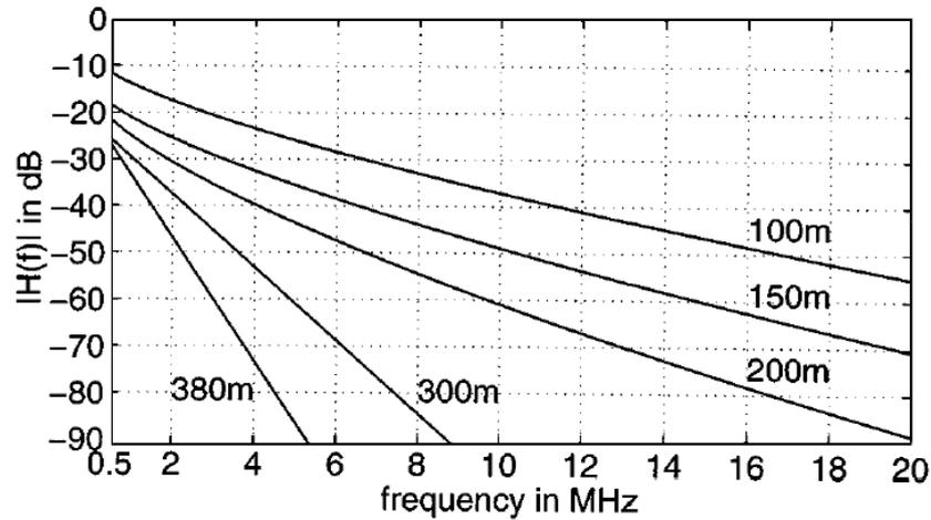
Figura 2.1: Atenuação dependente da distância e da frequência (Zimmermann & Dostert, 1999).
