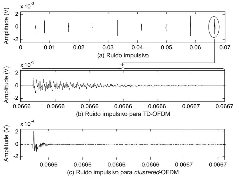
Figura 3.6: Ruído impulsivo visto pelo receptor no caso TD-OFDM e *clustered*-OFDM.
