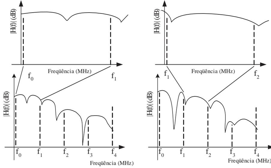
Figura 3.5: Ilustração do conceito *clustered-OFDM* para  $M = 4$  e para  $k = 1$  e  $k = 2$ .
