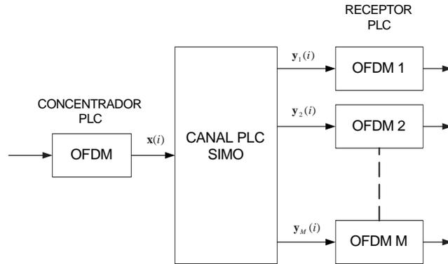
Figura 3.2: Sistema OFDM SIMO para uma transmissão de dados *downlink* em canais PLC.
