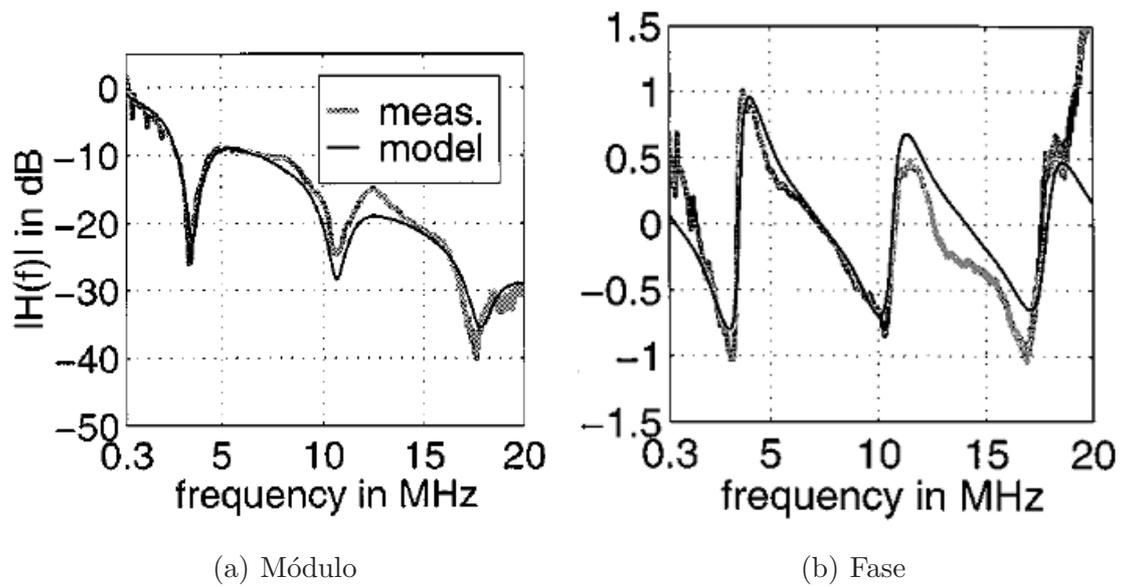
Figura 2.6: Módulo e Fase no domínio da frequência de um canal simulado e medido (Zimmermann & Dostert, 2002c ).
