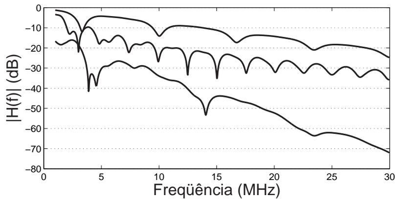
Figura 2.2: Módulo da amplitude da resposta em frequência de 3 canais PLC.
