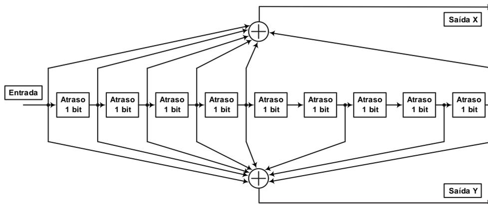
Figura 4.3: Diagrama de blocos do codificador convolucional (Samia, 2004).
