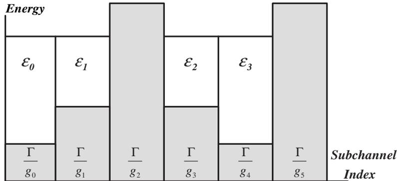
Figura 4.6: Ilustração do *waterfilling* para 6 sub-portadoras.
