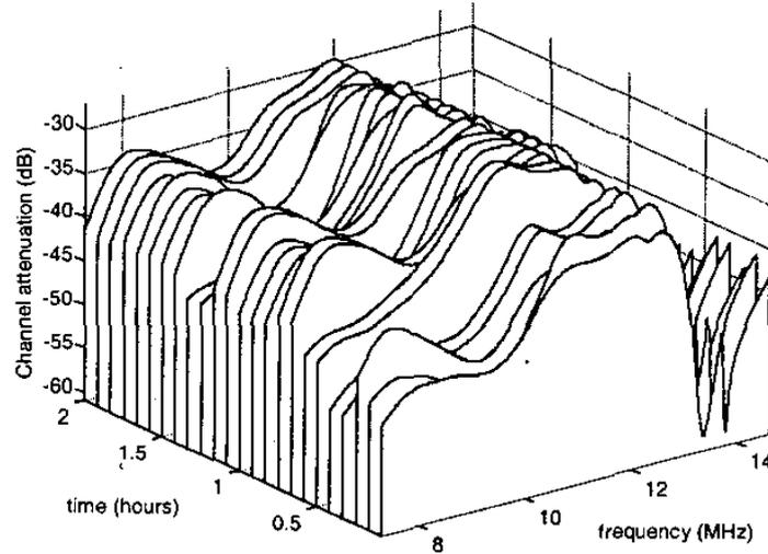
Figura 2.4: Evolução de um canal PLC para um período de 2 horas (Canete et al., 2002).
