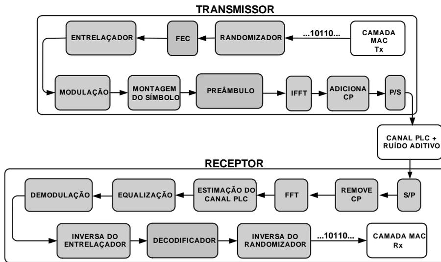
Figura 4.1: Diagrama de blocos de um sistema COFDM.
