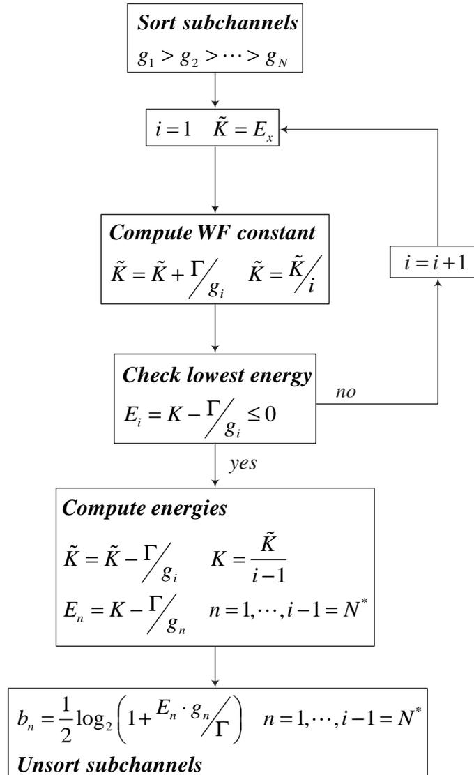
Figura 4.7: Fluxograma do algoritmo RA *waterfilling*.
