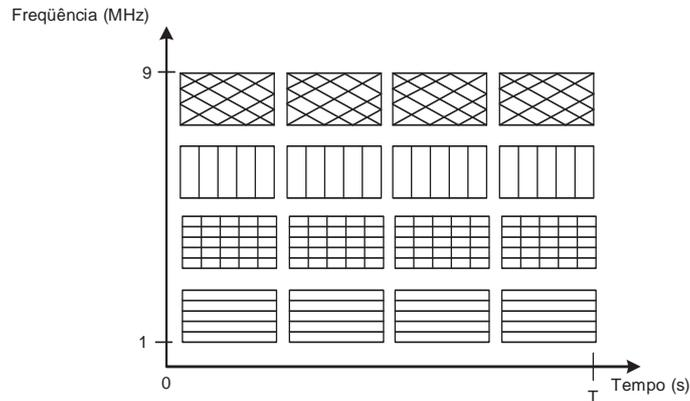
(b) Sistema *clustered*-COFDM.Figura 5.2: Alocação tempo x frequência dos sistemas *clustered*-COFDM e COFDM.
