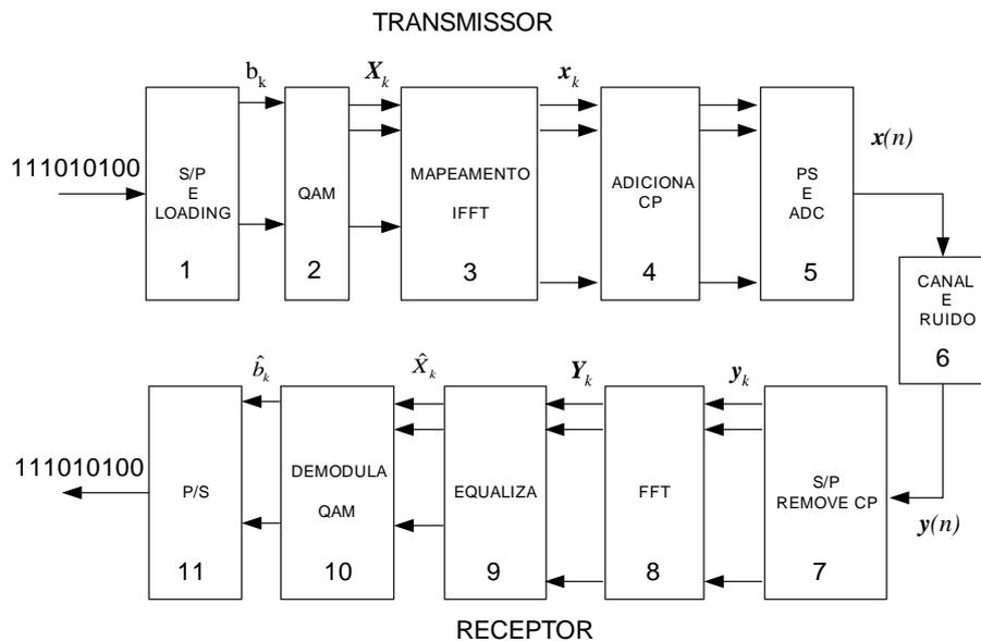
Figura 4.5: Diagrama esquemático dos sistemas de modulação OFDM/DMT.
