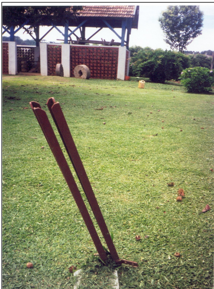
Figura 36: Base de lançamento de foguetes anti-granizo, utilizada a partir da década de 1970. Casa da Cultura Lydia Frey, Fraiburgo/SC. Fotografia tirada por Jó Klanovicz.
