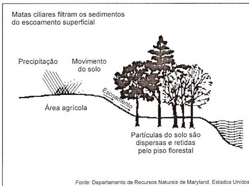
**Figura 1** - Filtragem dos sedimentos trazidos pelo escoamento superficial.
