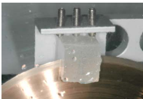
FIGURA 11 - Bloco de resina com implante sendo seccionado.
