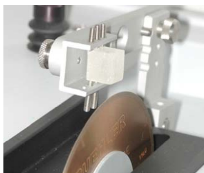
FIGURA 10 - Detalhe da superfície de corte com bloco de resina fixado.
