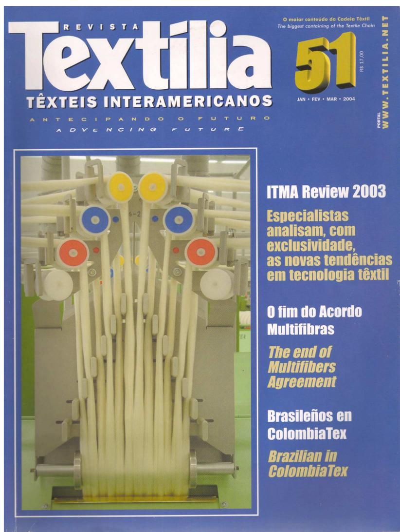
O plano de expressão desta capa focaliza, segundo os termos usados em sua matéria, a foto de uma urdideira automática, modelo circular com dupla frontura, equipada com listradores para 4 cores e Jacquard<sup>21</sup> eletrônico com
