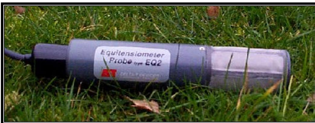
Figura 6.13: - Tensiômetro de Equivalência – Equitensiômetro EQ2 (Delta – T Devices, UK, 2000).
