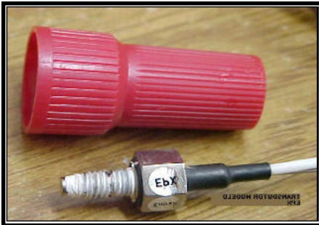
Figura 6.3: Transdutor de pressão modelo EPX da ENTRAN®.
