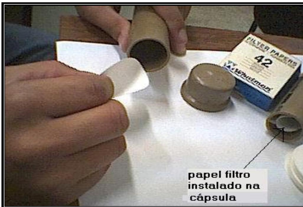
Figura 6.16: Papel filtro para determinação de sucção total
