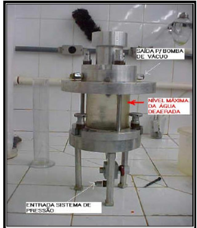
Figura 6.7-1: Câmara de calibração / saturação. Figura 6.7-2: Câmara de saturação da pedra porosa
