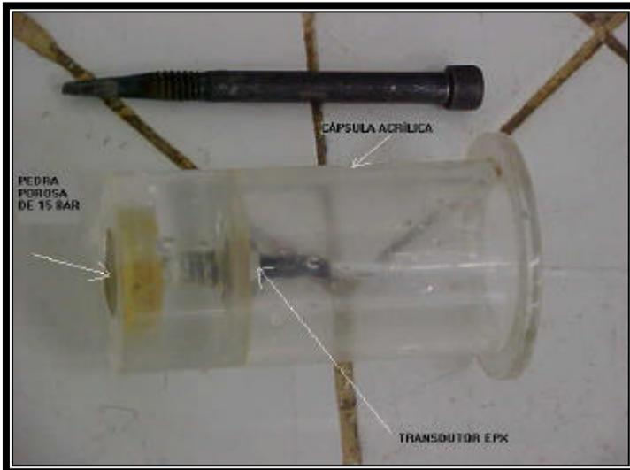
Figura 6.2 : - O tensiômetro TENSE EPX 1 montado.
