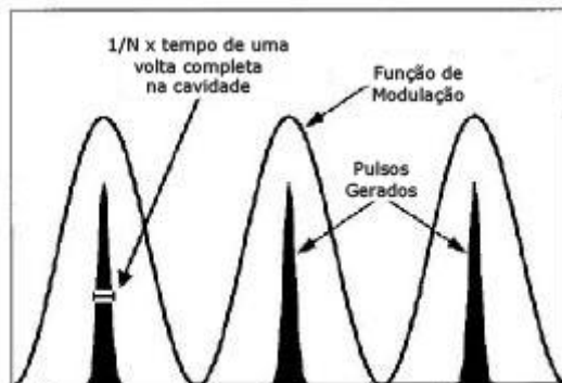
Figura 4.3 – Desenho conceptual de uma função de modulação em amplitude e do correspondente pulso localizado no laser com modos acoplados com modulação em amplitude (AM).
