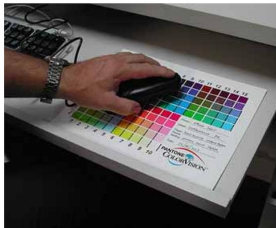
**Figura 6-11** Leitura das amostras de cores utilizando espectrocolorímetro de mão.
