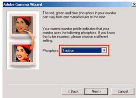
De acordo com (LYONS, 2002), Deve-se escolher entre Trinitron ou P22-EBU, quando não se sabe o tipo dos fósforos utilizados. Para saber se o monitor é Trinitron, basta observar se existem duas linhas finas horizontais, uma a  $\frac{1}{4}$  da parte superior e outra a  $\frac{1}{4}$  da parte inferior. Se existem essas linhas, escolha Trinitron, caso contrário escolha P22-EBU.
