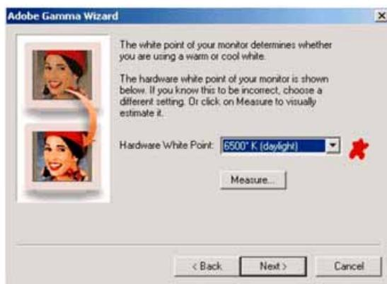
Ajusta-se o Ponto branco do monitor para 6500K, o que tem sido considerada a melhor opção. Deve-se realizar esta operação diretamente nos controles do monitor, pois alguns modelos têm o ponto branco padrão configurado em 9300K.
