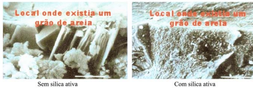
Figura 2.1.1 – Foto a partir de um microscópio eletrônico – Percebe-se que a inserção de sílica na produção do concreto o torna diversas vezes mais denso, aumentando diversas vezes a resistência mecânica do material.
