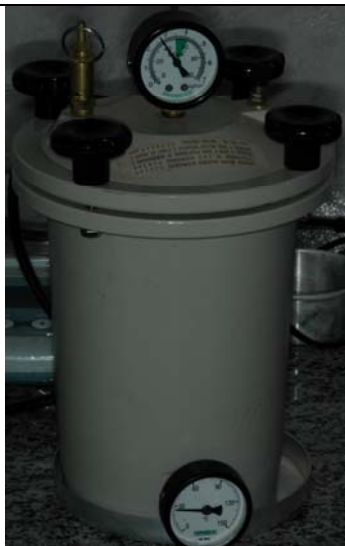
Fig.24–Dispositivo para remoção das bolhas internas dos modelos fotoelásticos durante a presa dos mesmos.
