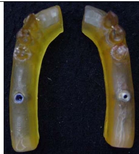
Fig. 25– Modelos fotoelásticos: hexágono interno (esquerda); hexágono externo (direita).
