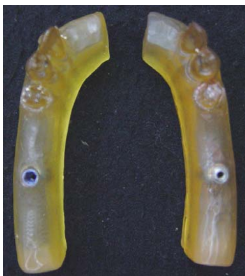
Fig. 3 - Modelos fotoelásticos: hexágono interno (esquerda); hexágono externo (direita).
