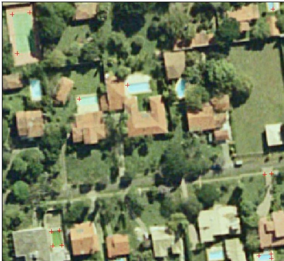
Figura 7.1 – Exemplos de pontos de controle bem definidos e extraídos da ortofoto 1:5.000 (visão em escala ampliada).
