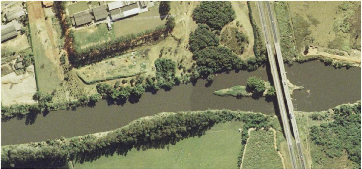
Figura 6.24 – Detalhe da ortofoto em região de emenda de mosaicação e ponte.
