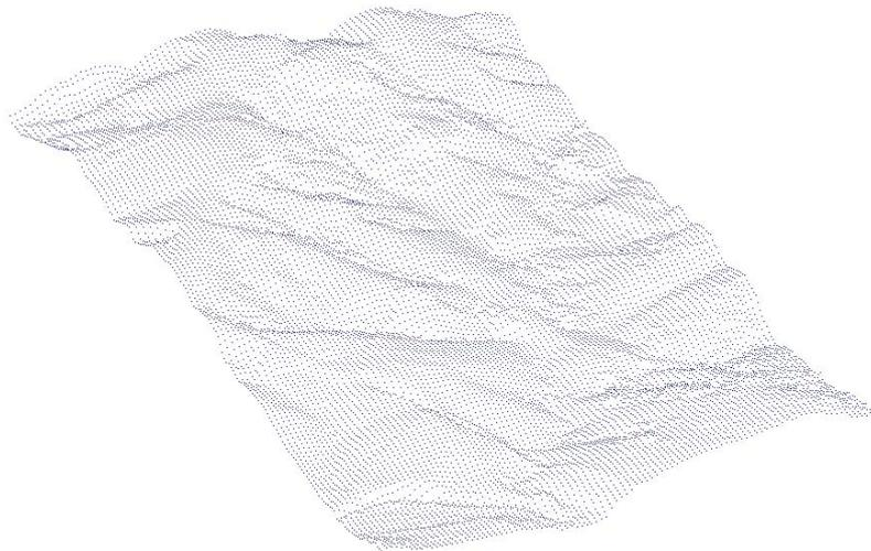
Figura 3.1 – Modelo digital de elevação representado em malha regular, visto em perspectiva isométrica.
