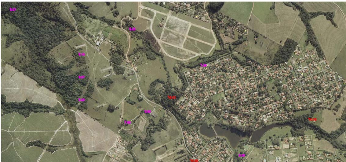
Figura 7.7 –Pontos do MDE com erros superiores a 5 metros.
