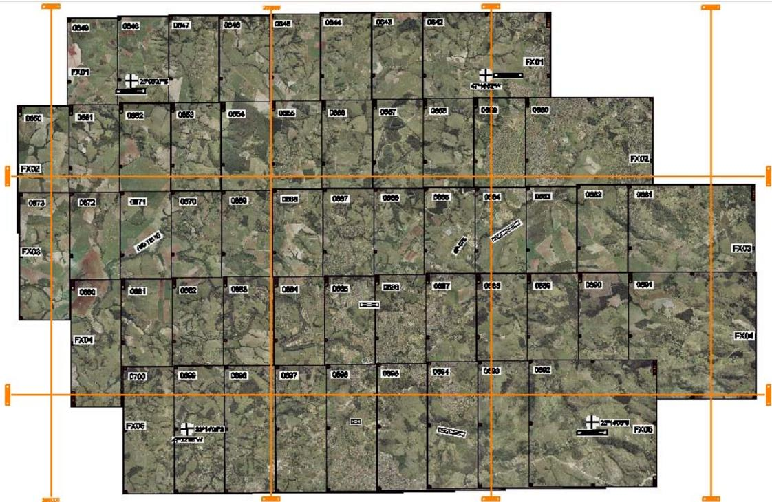
Figura 6.2 - Foto índice da cobertura 1:25.000 com malha aproximada em UTM.
