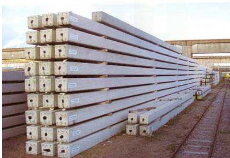
Figura 3: pilares de fundação executados com CAA (Fonte: Walraven, 2005)
