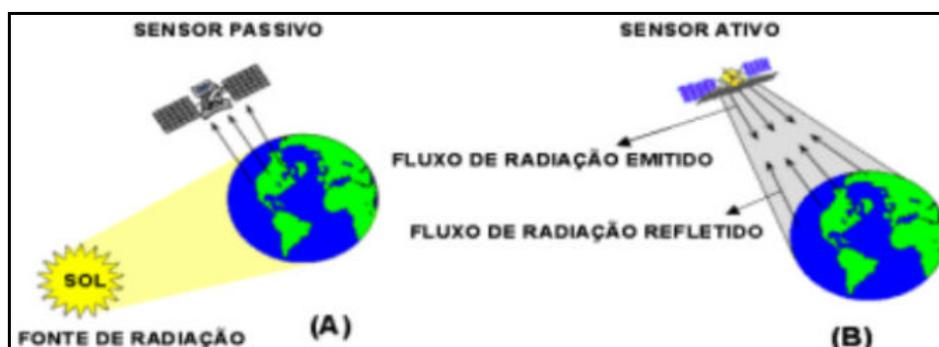
Fig.14: Sensores passivo (A) e ativo (B)
