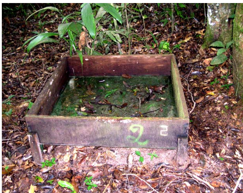
Figura 6 - Caixa de interceptação de serapilheira
