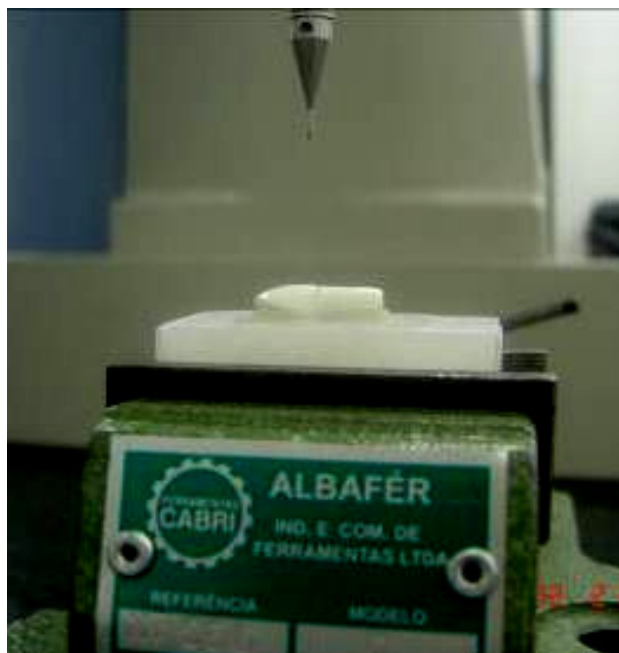
Figura 13 - Unidade de leitura do Aparelho de Medição Tridimensional modelo Hyper KN810 (Mitutoyo, Japão) com o dente apoiado no suporte acrílico
