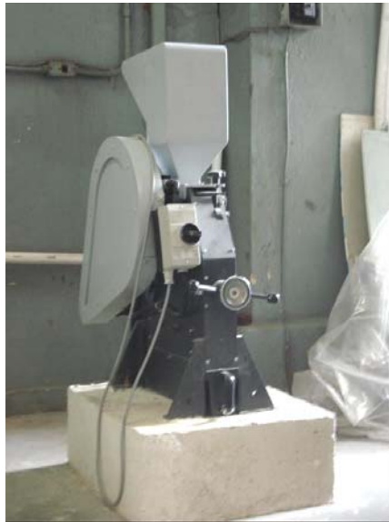
Figura 4.2 – Britador de mandíbula usado para triturar os resíduos de concreto.
