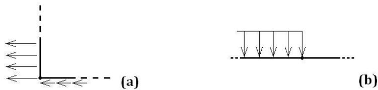
Figura 3.5 – exemplos de descontinuidades de funções no contorno: (a) tensões em um vértice; (b) mudança de carregamento
