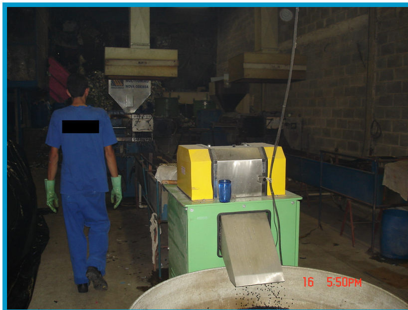
Figura VII.11 – Extrusoras de fio, com secadores de fio e picotadores
