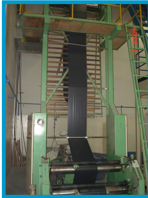
Figura VII.13 – Extrusora de balão
