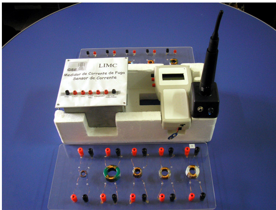
Figura 5.7.2.3 - Fotografia do sistema com sensor, gravador e transmissor
