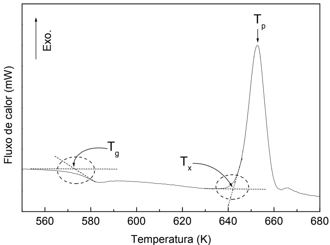
**Figura 41**-Curva de DSC do vidro  $10\text{Li}_2\text{O}-80\text{TeO}_2-10\text{WO}_3$ .
