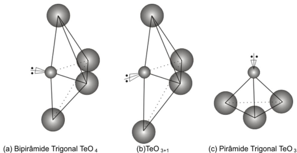
**Figura 9**-Ilustração<sup>6</sup> das coordenações do  $\text{TeO}_4$ : (a) bipirâmide trigonal,  $\text{TeO}_4$ , (b) poliedro,  $\text{TeO}_{3+1}$  e (c) pirâmide trigonal,  $\text{TeO}_3$ .
