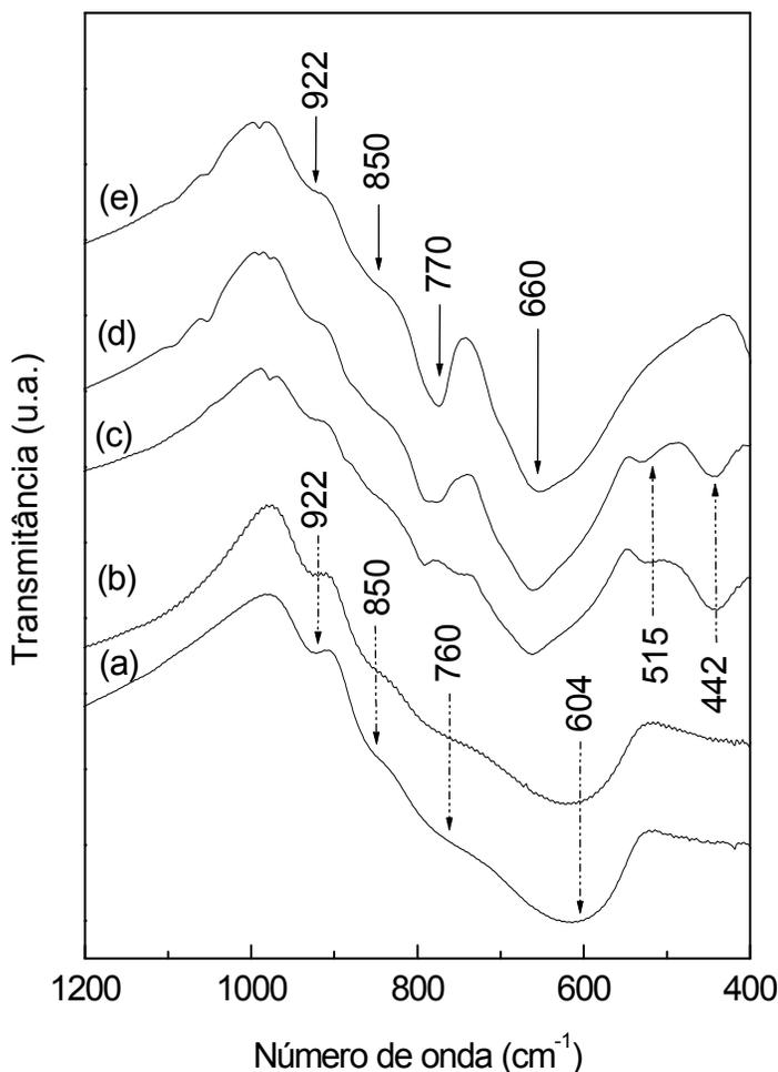
**Figura 21**-Espectros no infravermelho do vidro TLW-10: (a) como preparado e tratados termicamente a 658 K (b), 681 K (c), 689 K (d) e 713 K (e). Medidas realizadas para partículas  $< 38\ \mu\text{m}$ .
