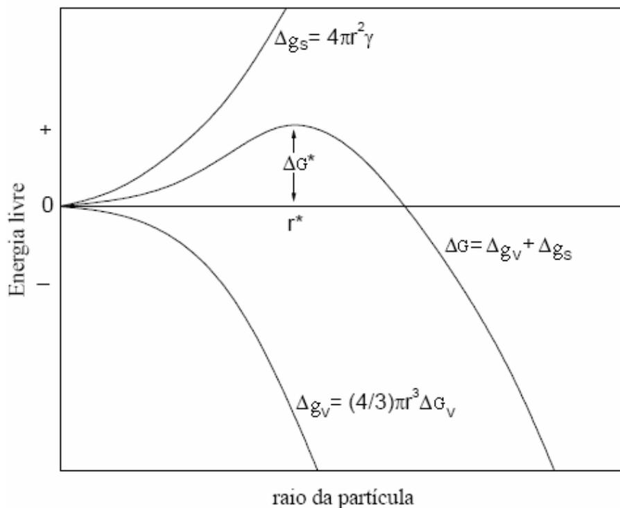
**Figura 6**-Variação de energia livre com o raio da partícula para a formação de um núcleo sólido esférico a partir de um líquido<sup>16</sup>.
