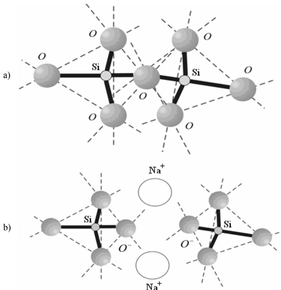
**Figura 4**-Quebra da ligação<sup>1</sup> Si-O-Si devido ao modificador  $\text{Na}_2\text{O}$ , a) cadeia sem sofrer ação do modificador e b) formação do par de oxigênios não ligados Si-O<sup>-</sup>.
