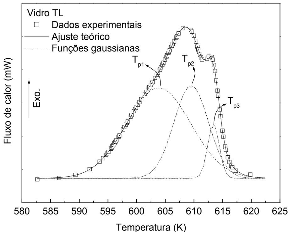
**Figura 24**-Exemplo do método de deconvolução utilizado para determinar as temperaturas ( $T_{p1}$ ,  $T_{p2}$  e  $T_{p3}$ ) dos picos de cristalização dos vidros teluretos. Foi utilizada como exemplo a curva de uma amostra TL.
