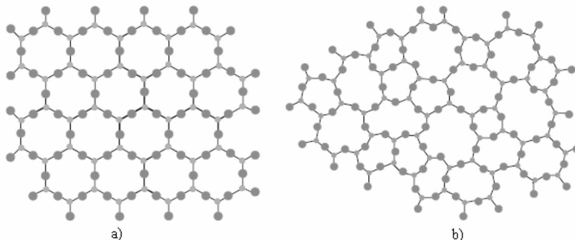
**Figura 1-**Representação bidimensional<sup>4</sup>. a) Arranjo simétrico e periódico de um cristal, b) representação da rede desordenada de um vidro sem periodicidade e simetria.
