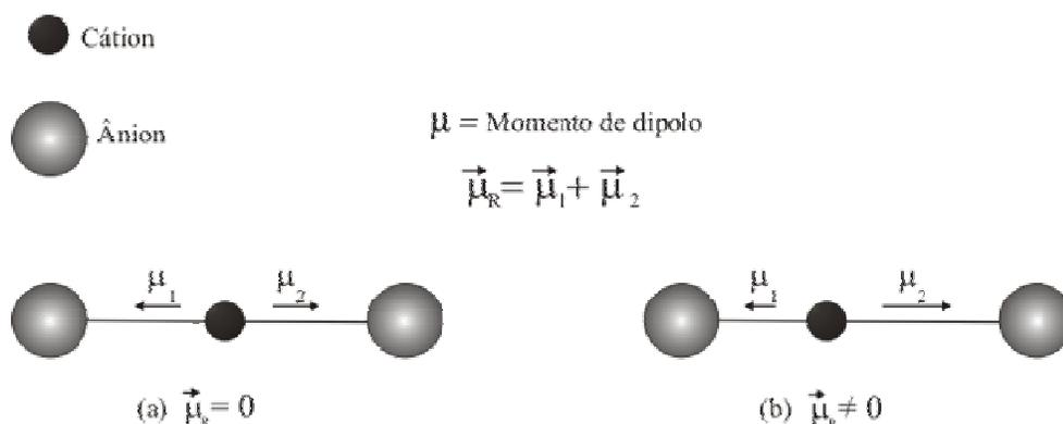
Figura 44-Exemplo dos modos vibracionais no infravermelho<sup>6</sup>: (a) inativo e (b) ativo.
