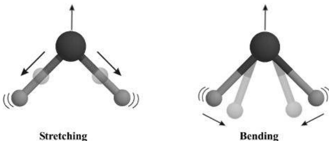
Figura 43-Principais modos vibracionais no infravermelho<sup>39</sup>.
