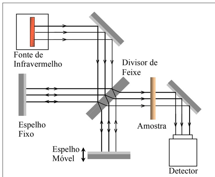
**Figura 45**-Arranjo típico de um espectrômetro de infravermelho.
