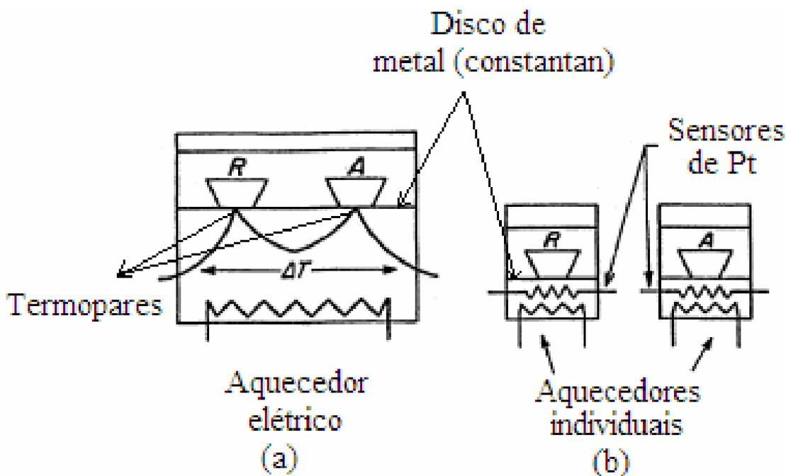
**Figura 40**-Esquema dos dois tipos básicos de DSC<sup>36</sup>: a) DSC por fluxo de calor e b) DSC por compensação de potência.
