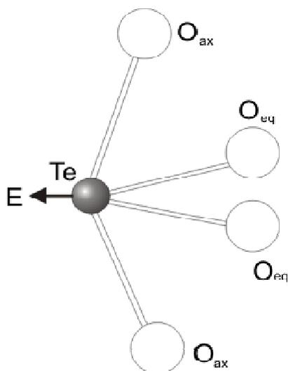
**Figura 10**-Modelo estrutural para as unidades  $\text{TeO}_4$  presentes nas fases cristalinas  $\alpha$  e  $\beta\text{-TeO}_2$  (a seta indica a posição do par de elétrons livres do átomo de telúrio)<sup>6</sup>.
