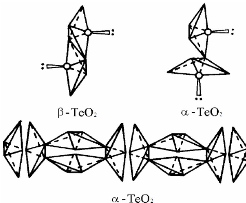
**Figura 8**-Estrutura básica do  $\alpha$ -TeO<sub>2</sub> (paratellureto) e do  $\beta$ -TeO<sub>2</sub> (tellureto)<sup>22</sup>.
