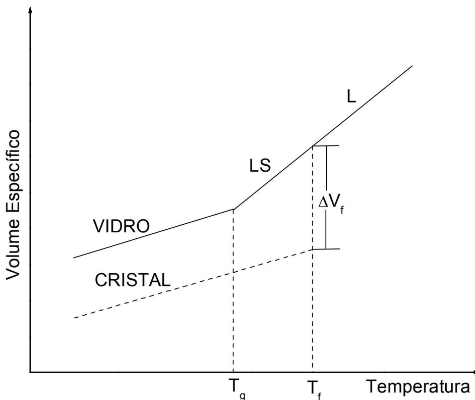
**Figura 2-**Definição da temperatura de transição vítrea<sup>13</sup> (L: líquido, LS: líquido super-resfriado).
