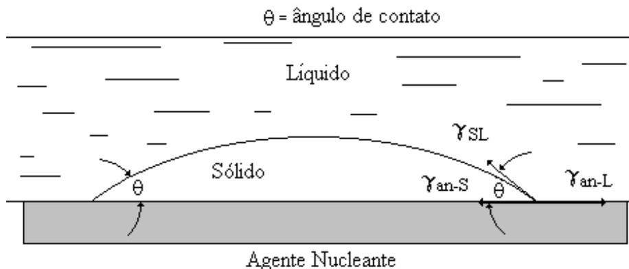
Figura 7-Nucleação heterogênea de um sólido em um líquido<sup>16</sup>.
