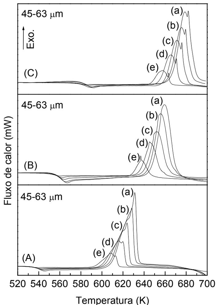
**Figura 23**-Curvas de DSC para os vidros teluretos: (A) TL, (B) TLW-5 e (C) TLW-10. Para partículas com tamanhos 45-63  $\mu\text{m}$  e para as diferentes taxas de aquecimento: (a) 12.5  $\text{K}\cdot\text{min}^{-1}$ , (b) 10  $\text{K}\cdot\text{min}^{-1}$ , (c) 7.5  $\text{K}\cdot\text{min}^{-1}$ , (d) 5  $\text{K}\cdot\text{min}^{-1}$  e (e) 2.5  $\text{K}\cdot\text{min}^{-1}$ .
