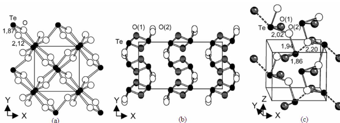
**Figura 11**-Estrutura<sup>28</sup> dos diferentes polimorfos cristalinos  $\text{TeO}_2$ : projeção bidimensional da rede (a)  $\alpha\text{-TeO}_2$  e (b)  $\beta\text{-TeO}_2$ ; (c) estrutura espacial da rede  $\gamma\text{-TeO}_2$  (os contatos entre as cadeias vizinhas  $\text{TeO}_2$  são mostradas pelas linhas tracejadas).
