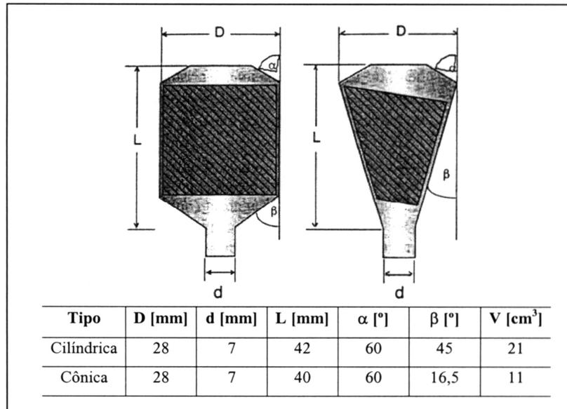
Figura 3.9 – Geometrias de Pré-Câmara, WOLFF (1997)
