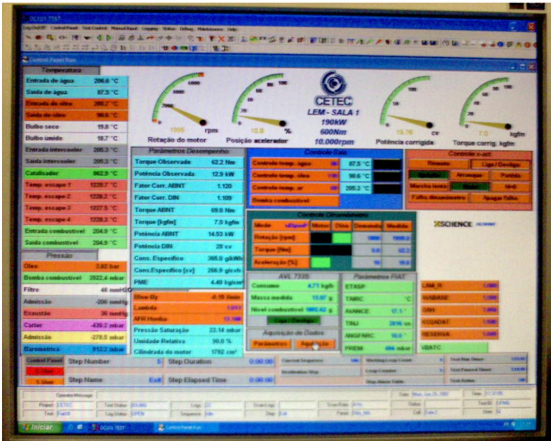
Figura 4.24 – Software de Controle do Dinamômetro, SCHENK DC101
