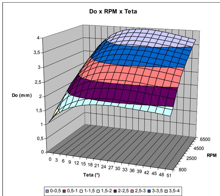
Figura 4.5 – Diâmetro do Orifício para Razão de Volumes 7,3 %
