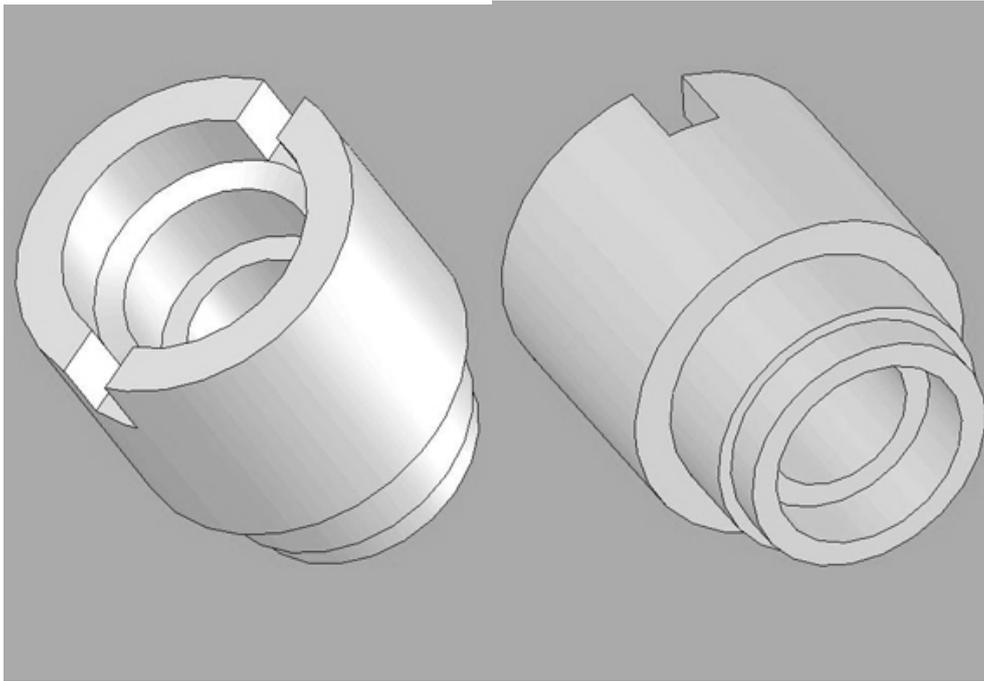
Figura 4.19 – Corpo Superior da Pré-Câmara com Vela Centralizada
