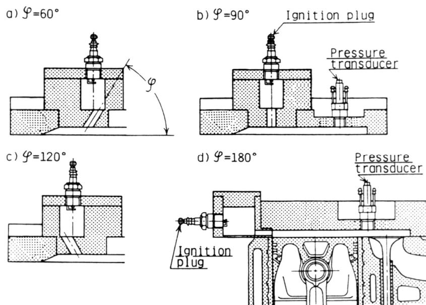
Figura 3.10 – Posições da Pré-câmara, RYU (1987)
