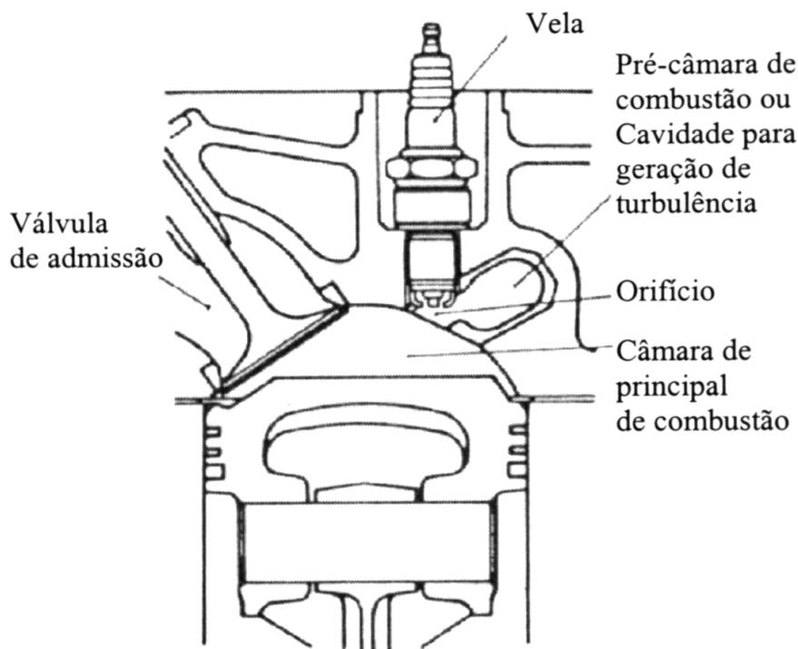
Figura 3.8 – Célula Geradora de Turbulência, HEYWOOD (1988)
