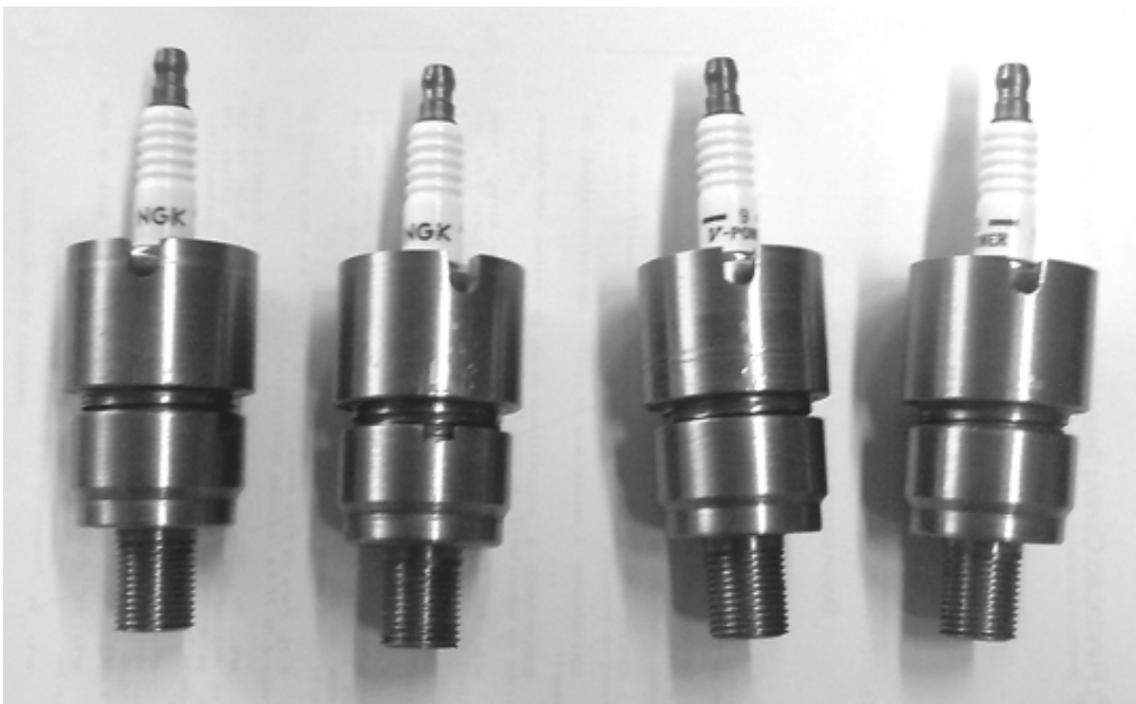
Figura 4.20 – Conjunto de Pré-Câmaras com Vela Centralizada
