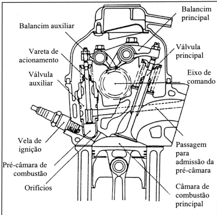
Figura 3.4 – Sistema CVCC da Honda – Corte Esquemático, TURKISH (1975)
