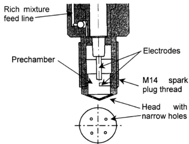
Figura 3.12 – Sistema APIR, ROBINET et al (1999)
