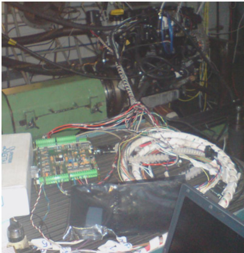
Figura 4.22 – Chicote e Central Experimental conectados ao Motor
