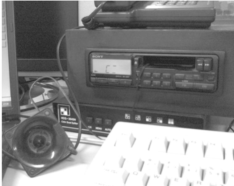
Figura 4.26 – Rádio conectado ao Sensor de Detonação
