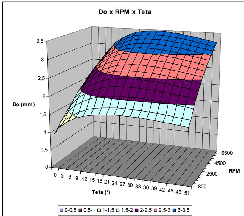
Figura 4.6 – Diâmetro do Orifício para Razão de Volumes 5 %
