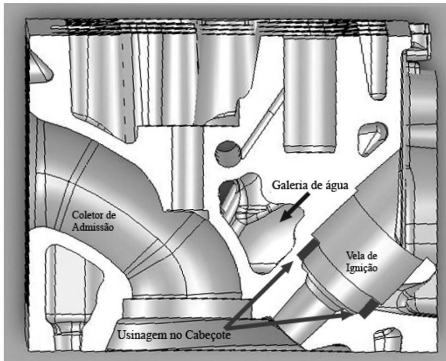
Figura 4.15 – Esquema do Cabeçote para Arrefecimento da Pré-Câmara
