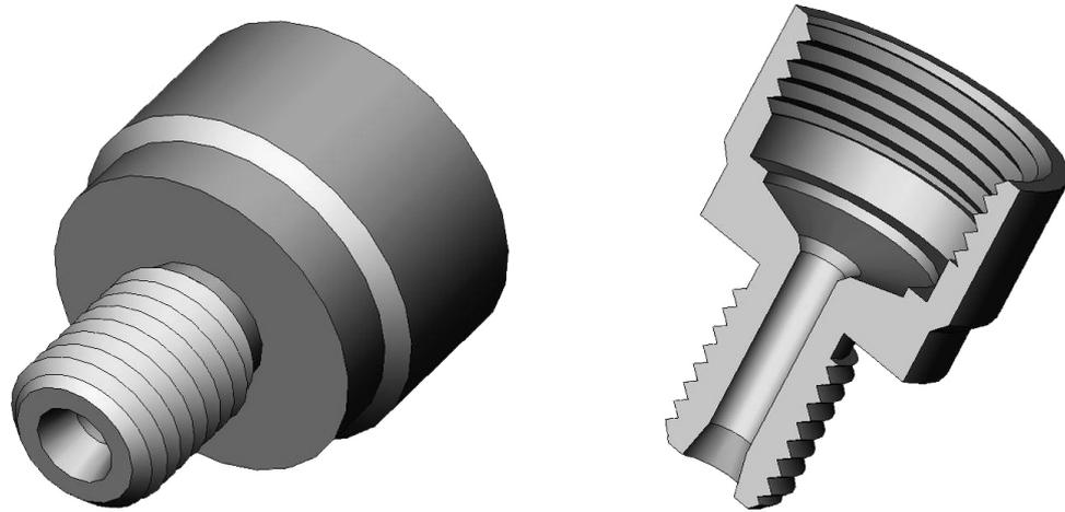
Figura 4.7 – Nozzle de Pré-câmara da Configuração 1
