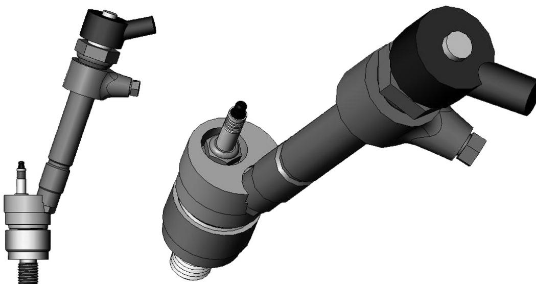
Figura 4.14 – Montagem da Pré-câmara com Vela e Eletroinjetor
