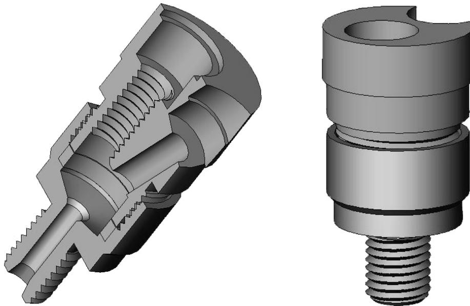
Figura 4.2 – Pré-câmara de Combustão projetada para Estratificação de Mistura
