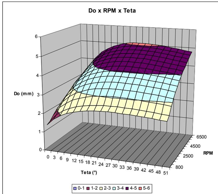
Figura 4.4 – Diâmetro do Orifício para Razão de Volumes 15 %
