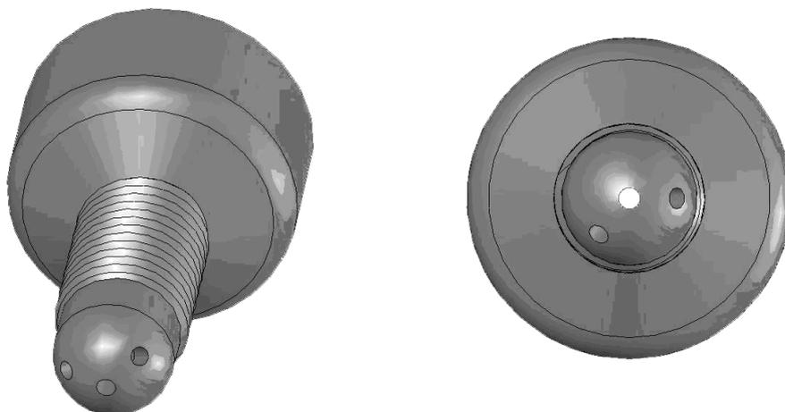
Figura 4.8 – Nozzle de Pré-câmara da Configuração 2
