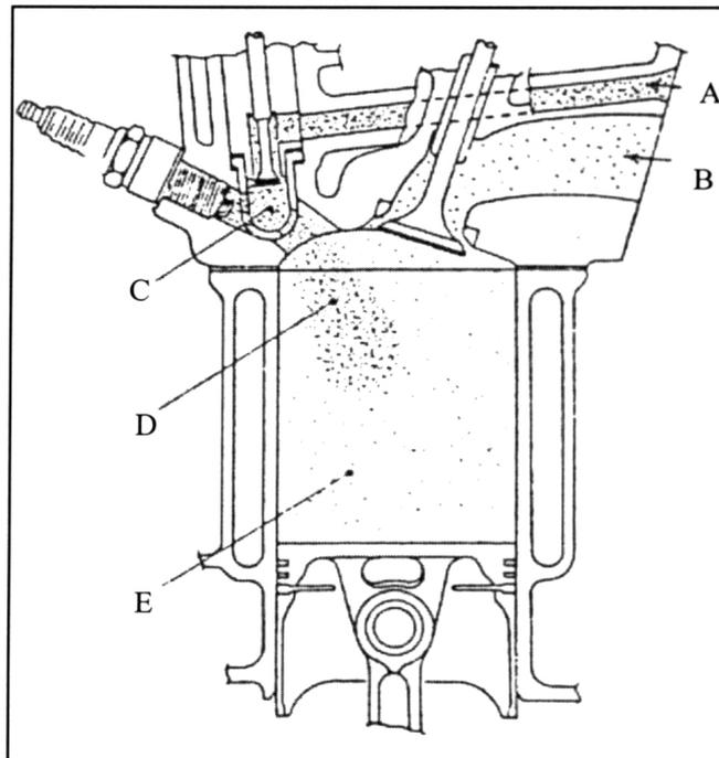
Figura 3.7 – Regiões de Estratificação de Mistura, DATE (1974)
