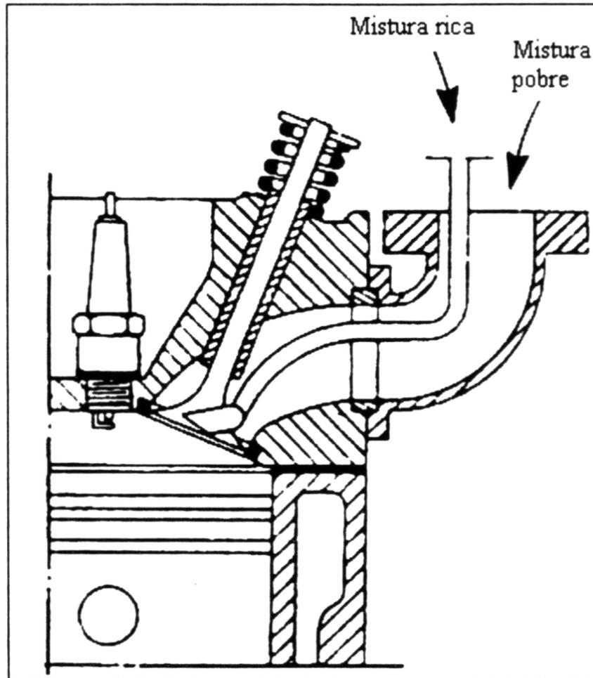
Figura 3.2 – Sistema Francês de Estratificação de Carga, GARRET (1996)
