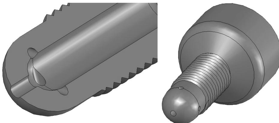
Figura 4.9 – Nozzle de Pré-câmara da Configuração 3
