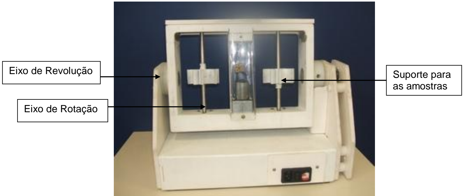
Figura 2.7: Clinostato 3D do Centro de Microgravidade/PUCRS Fonte: www.pucrs.br/feng/microg
