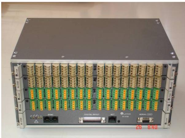
Figura 7.31 – Sistema de aquisição de dados LYNX com as placas 2160 e 2161.
