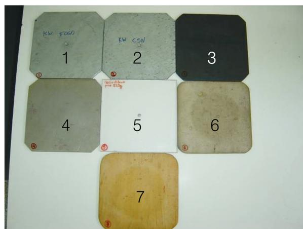
Figura 7.10 – Tipos de paredes utilizadas no ensaio de cisalhamento com a parede.
