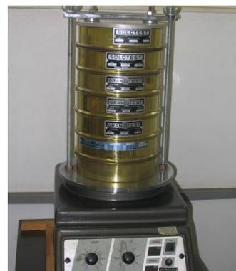
Figura 7.6 – Aparelho de ensaio granulométrico (Solotest modelo).
