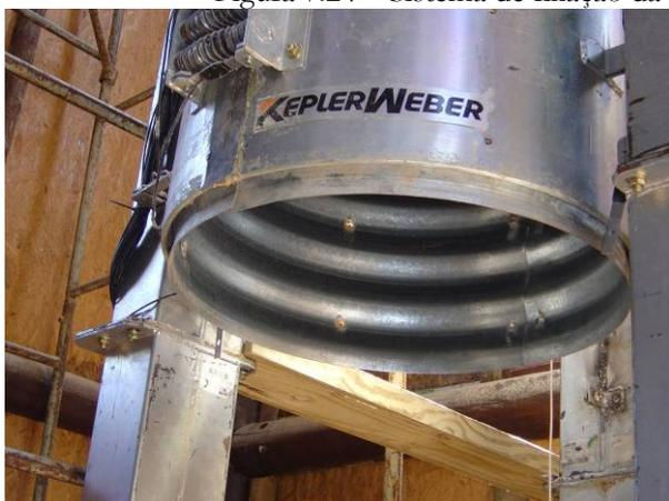
Figura 7.25 – Revestimento em chapa ondulada dos anéis.
