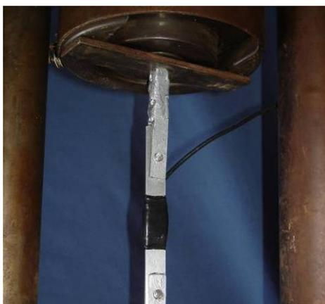
Figura 7.33 – Calibração das células de carga.
