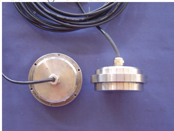
Figura 7.30 – Células de pressão MSI (cap.70 kPa).
