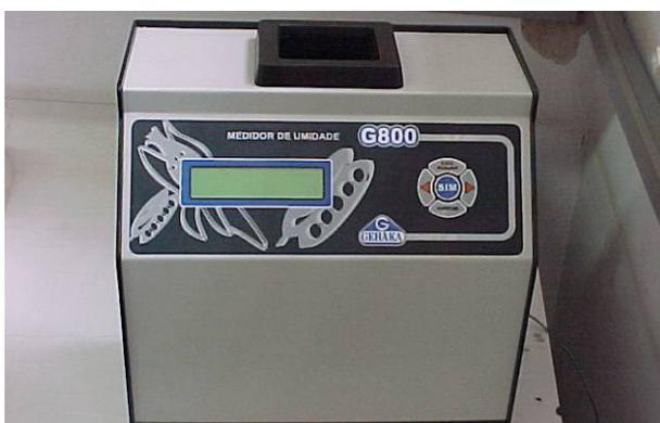
Figura 7.4 – Aparelho *flonthru*, para as medidas de umidade, temperatura e densidade.
