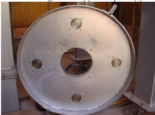
Figura 7.29 – Instrumentação do fundo plano.
