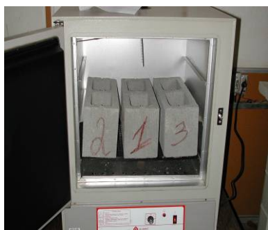
a) Secagem dos blocos na estufa até constância de massa
