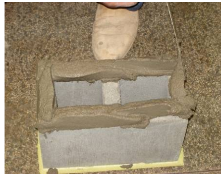
b) disposição dos cordões de argamassa
