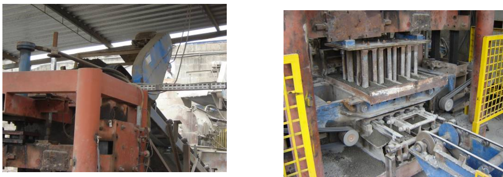
Figura 7.32 – Vibro-prensa utilizada para a produção dos meios-blocos.
