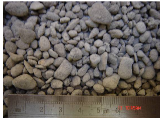
ARvp – agregado reciclado de resíduos gerados durante a etapa de vibro-prensagem dos blocos
