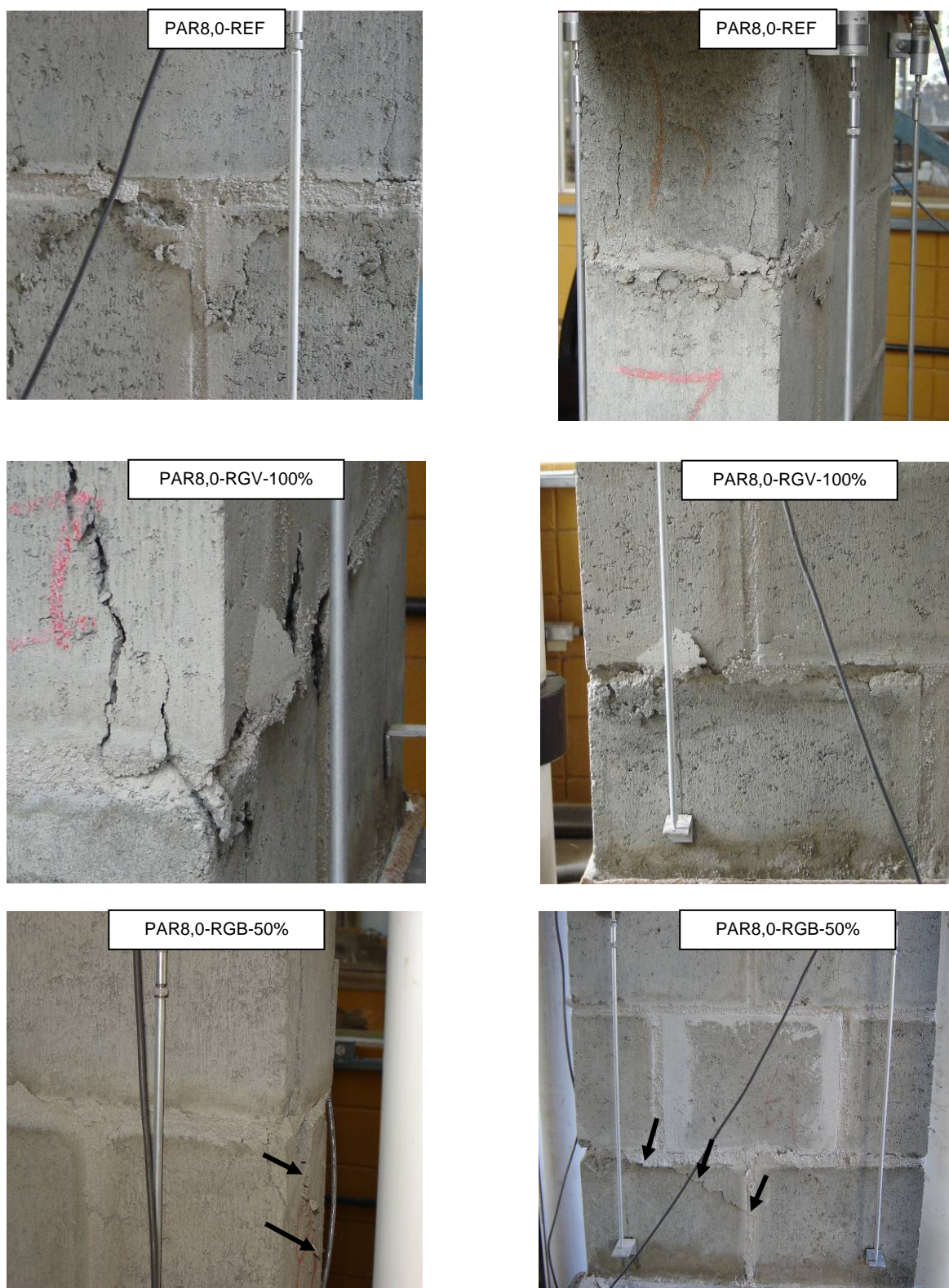
Figura 8.12 – Ruptura típica das miniparedes do Grupo 8,0.
