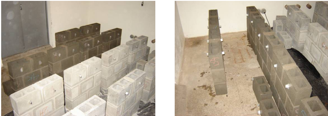
Figura 9.17 – Miniparedes do Grupo 8,0 dispostas na câmara climatizada.
