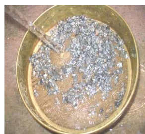
c) lavagem do material na peneira 1,20mm
