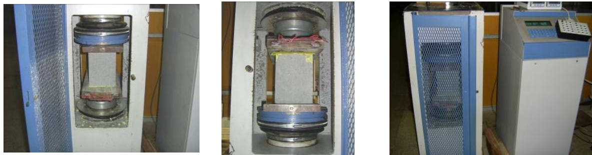
Figura 15 – Prensa hidráulica utilizada nos ensaios de resistência à compressão dos blocos de concreto.
