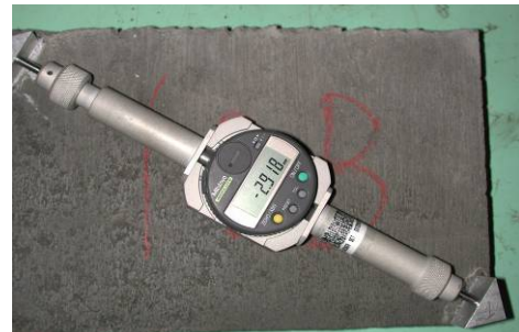
Figura 9.5 – Procedimento de leitura adotado para os corpos-de-prova de blocos.
