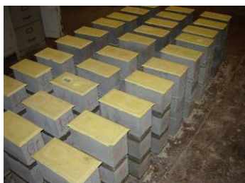
Figura 31 – Execução da segunda junta de argamassa, nivelamento do prisma e unidade superior.
