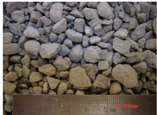
ARpb – agregado reciclado de resíduos gerados durante a produção dos blocos
