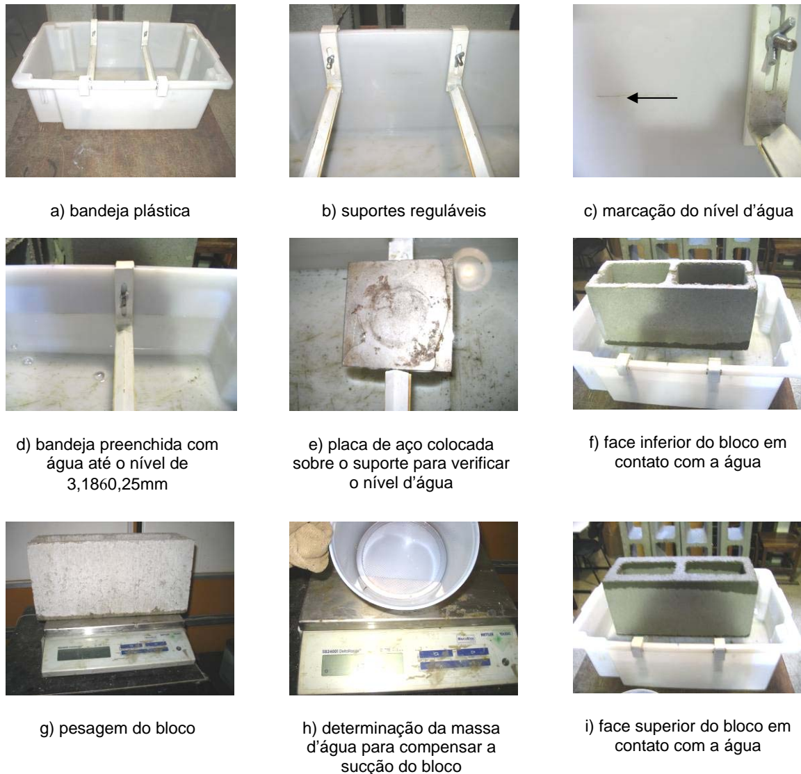
Figura 13 – Equipamentos e alguns detalhes do ensaio da taxa de absorção inicial de água (IRA).
