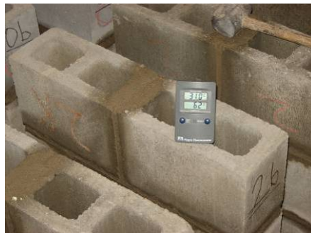
Figura 35 – Registro da temperatura e umidade no local de produção das miniparedes.
