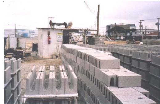
d) blocos canaletas
