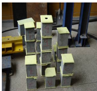
a) capeamento dos meio-blocos
