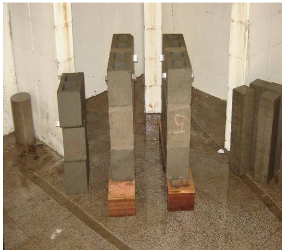
Figura 9.16 – Miniparedes do Grupo 8,0 dispostas na câmara úmida.
