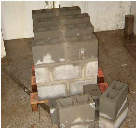
Figura 9.16 – Miniparedes do Grupo 8,0 dispostas na câmara úmida.
