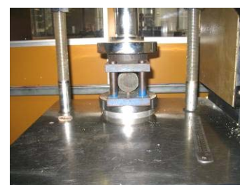
c) Ensaio de tração indireta na máquina Soiltest
