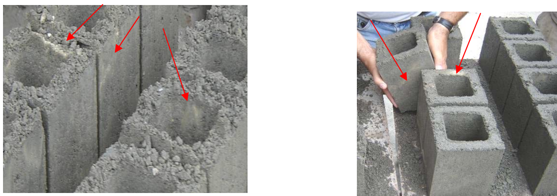
Figura 7.40 – Mistura deficiente dos materiais (MB4,5-REF).
