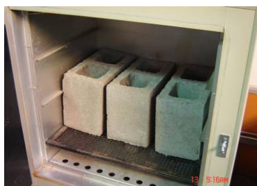
a) colocação das unidades na estufa (T=60°C e t=48h)
