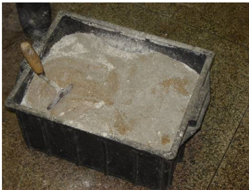
a) mistura preliminar dos materiais a seco
