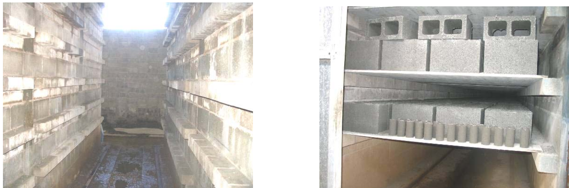
Figura 6.8 – Processo de cura térmica aplicada aos blocos e respectivos corpos-de-prova.
