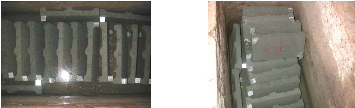
Figura 9.6 – Corpos-de-prova de blocos dispostos em tanque com água.
