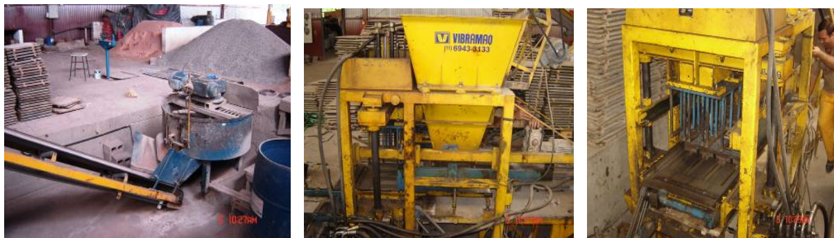
Figura 2.11 – Equipamentos utilizados para a produção de blocos de concreto (foto do autor).
