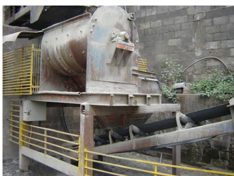
Figura 7.34 – Detalhe do misturador mecânico utilizado na produção dos meios-blocos.
