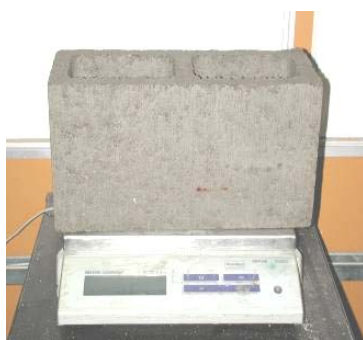
b) Pesagem dos blocos na balança
