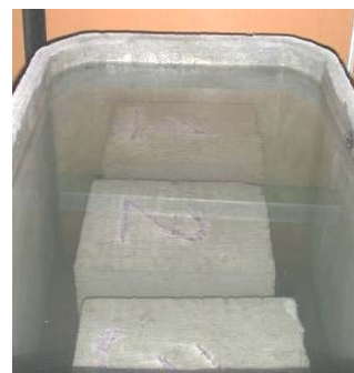
c) Imersão dos blocos na água por no mínimo 24 horas
