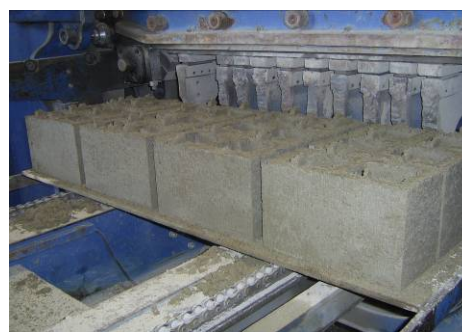
Figura 7.4 – Vibro-prensa utilizada para a produção dos blocos de concreto.
