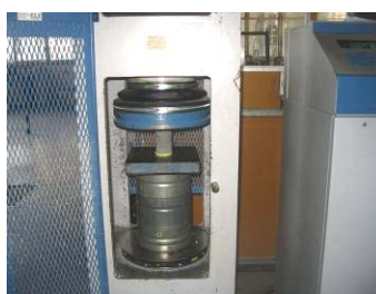
b) Ensaio de compressão na máquina ELE - Autotest
