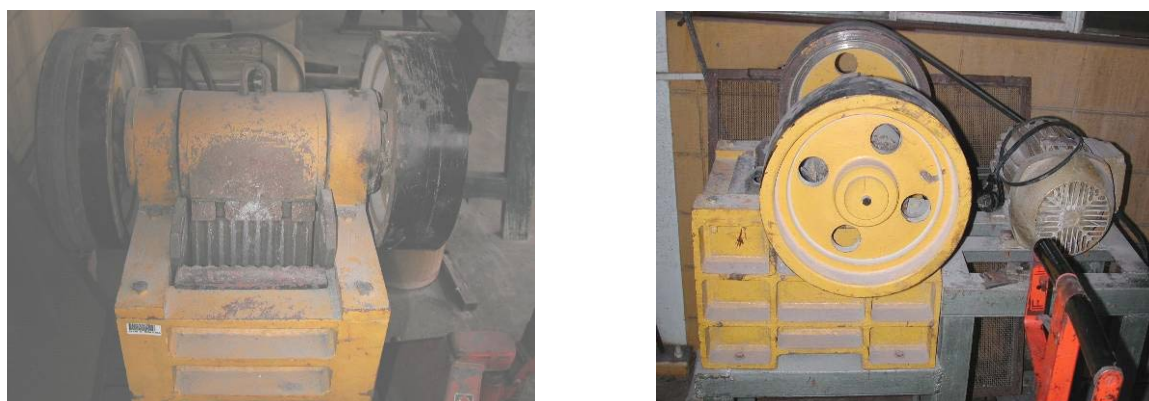
Figura 5.3 – Britador de mandíbulas utilizado para o processamento dos resíduos.
