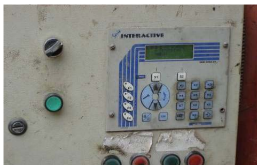
Figura 7.36 – Painel de ajuste dos tempos de produção.
