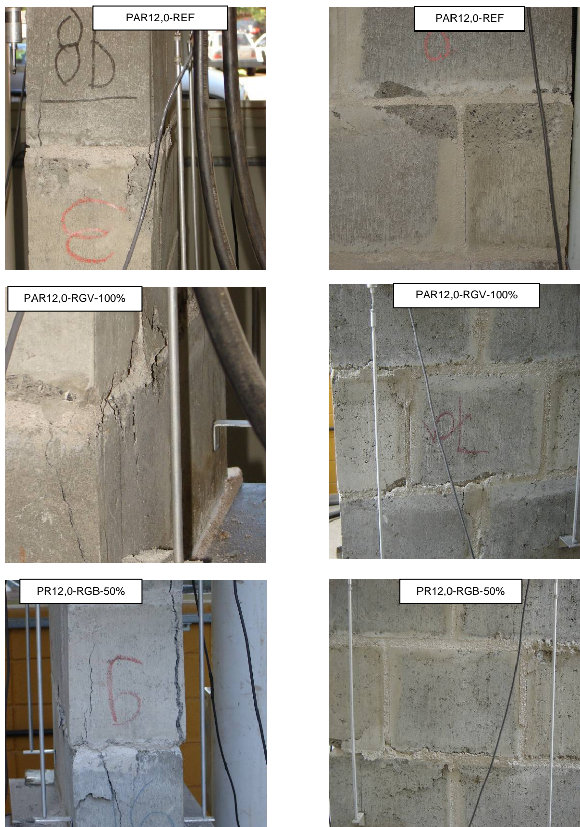
Figura 8.13 – Ruptura típica das unidades do Grupo 12,0.
