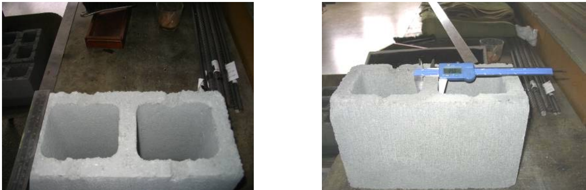
Figura 10 – Blocos verificados dimensionalmente.
