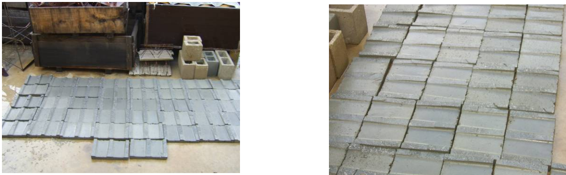
Figura 9.4 – Corpos-de-prova de blocos (prismas).
