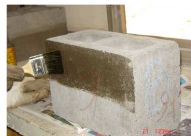
c) aplicação da demão de resina acrílica impermeabilizante
