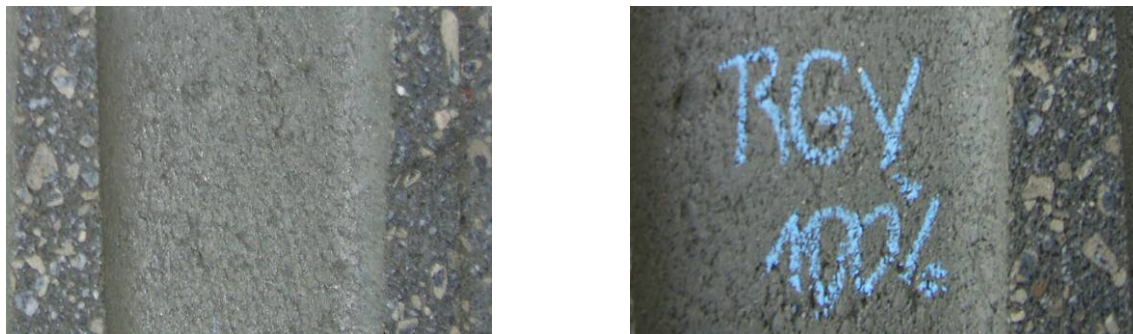
Figura 7.16 – Presença dos agregados reciclados no traço B4,5-RGV-100%.
