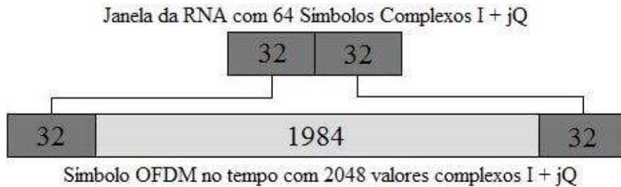
Figura 5.4 – Montagem da Janela da RNA
