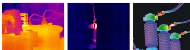
Fig. 15 – Exemplos do uso da termovisão.
