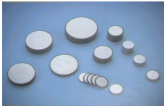
Fig. 2 – Varistores de ZnO em diversas dimensões.
