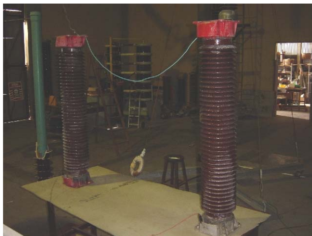
Fig. 82 - Pára-raios PR4 e PR5 cobertos por poluição salina.
