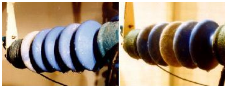
Fig. 27 – Desgaste provocado por poluição superficial e formação de bandas secas (CHRZAN, 2003).
