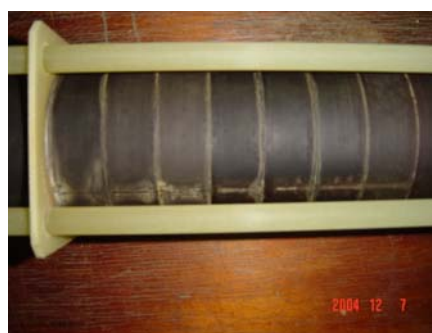
Fig. 36 - Marca de descarga elétrica.
