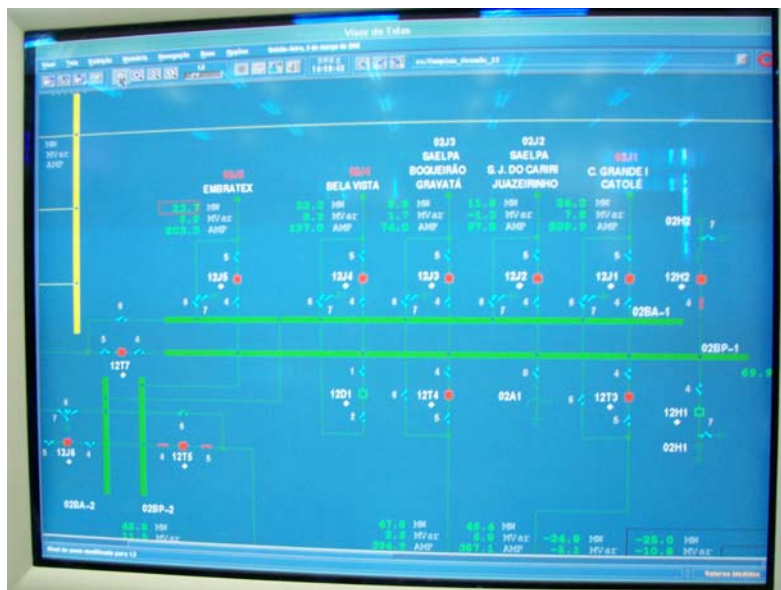
Figura 35: Interface de Supervisão de uma Subestação de Energia Elétrica
