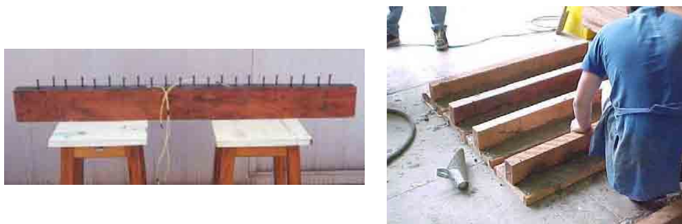
Figura 2.42 – Detalhes das vigas mistas. Fonte: SORIANO (2001)
