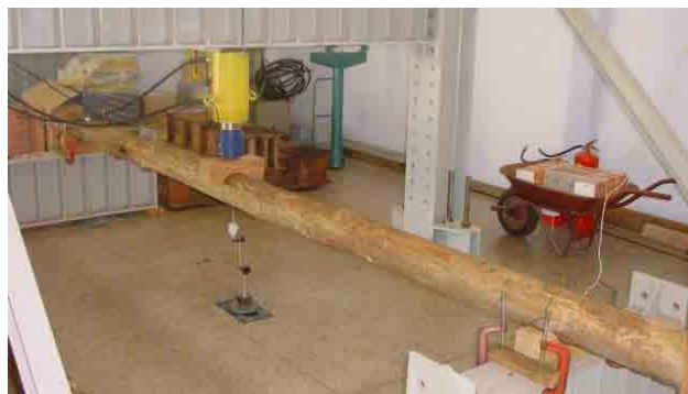
Figura 6.2 – Ensaio de flexão estática nas vigas de madeira bruta
