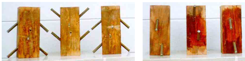
Figura 4.4 – Modo de colocação dos pinos inclinados nos corpos-de-prova mistos de madeira-concreto
