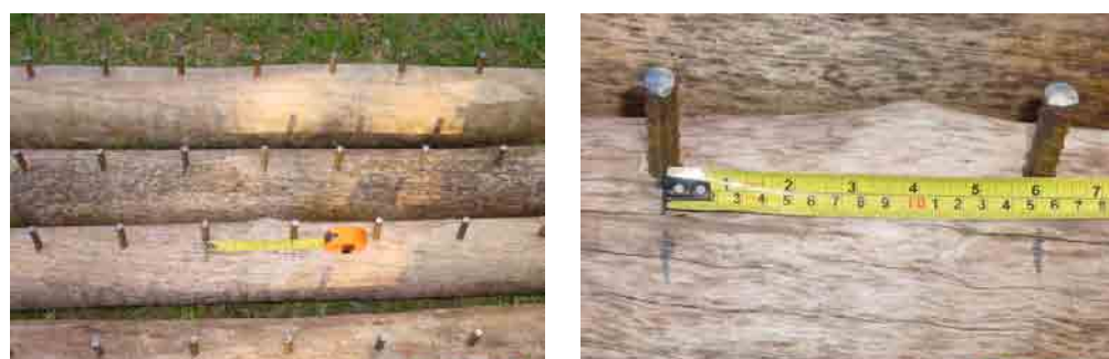
Figura 6.6 – Vigas com pinos e verificação da distância entre pinos
