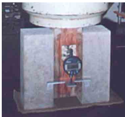
Figura 4.6 – Ensaio dos corpos-de-prova de madeira-concreto
