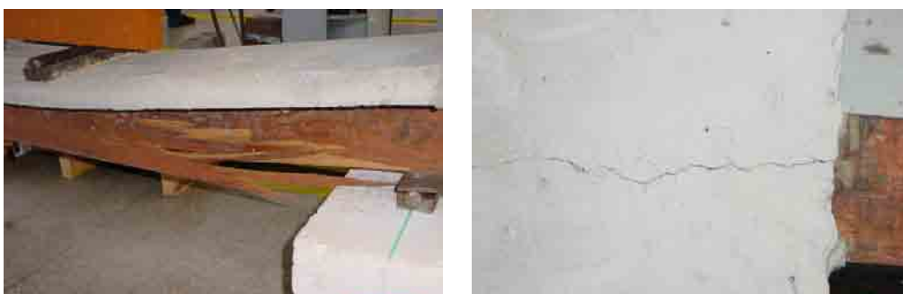
Figura 5.10 – Ruptura por tração na madeira e ruptura na linha de conectores da viga 7
