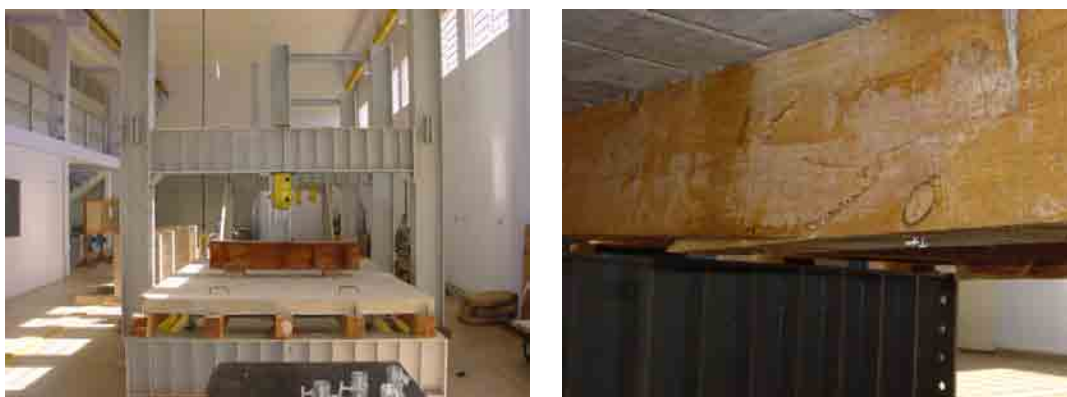
Figura 2.51 – Ensaio do modelo experimental e ruptura das vigas. Fonte: SOUZA (2003)
