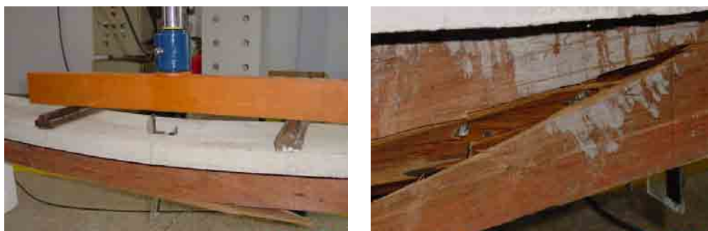
Figura 5.11 – Ruptura por tração na região central da viga 8
