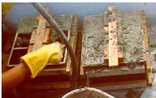
Figura 4.5 – Concretagem dos corpos-de-prova de madeira-concreto
