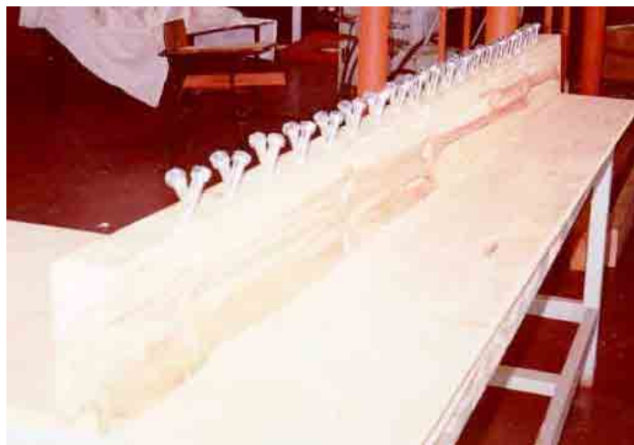
Figura 2.38 – Parafusos na viga de madeira. Fonte: MATTHIESEN (2001)
