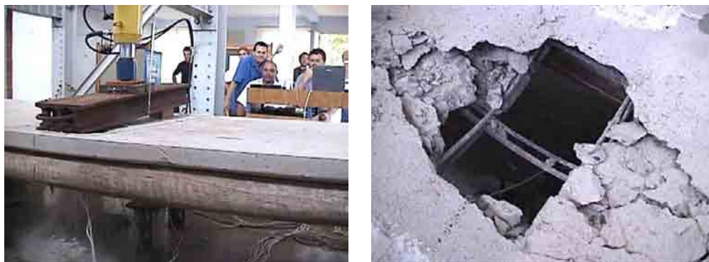
Figura 6.21 – Ruptura do tabuleiro misto de madeira-concreto com carregamento simulando o trem-tipo
