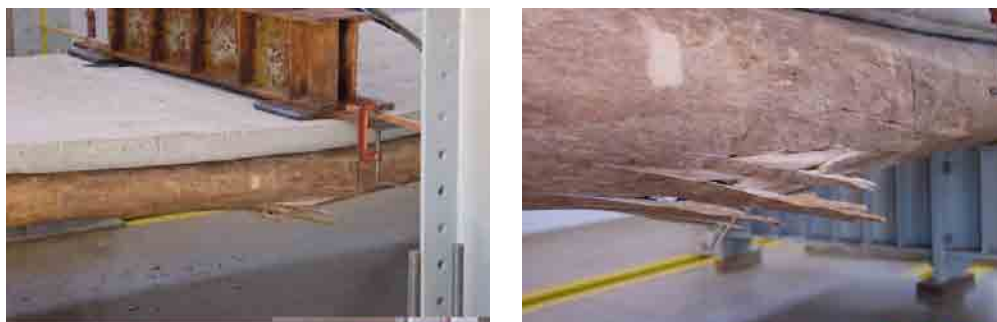
Figura 6.23 – Ruptura das vigas de madeira do tabuleiro misto de madeira-concreto com carregamento distribuído
