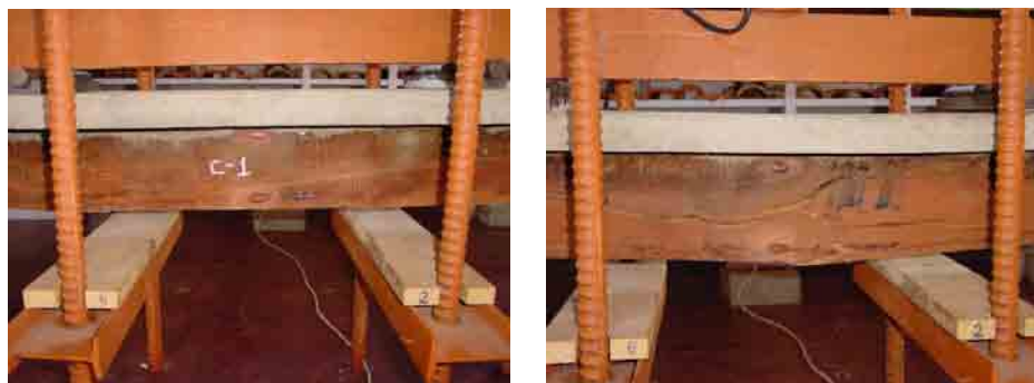
Figura 5.8 – Ruptura nos pontos de aplicação da força nas vigas 1 e 2
