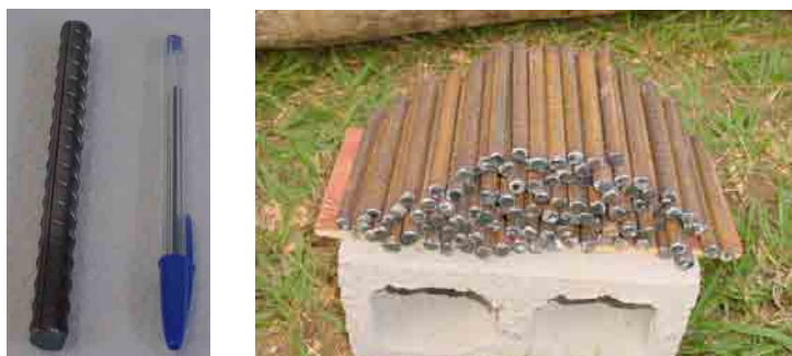
Figura 6.3 – Pinos utilizados na construção do tabuleiro misto de madeira-concreto
