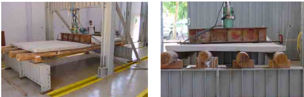
Figura 6.22 – Ensaio do tabuleiro misto de madeira-concreto com carregamento distribuído
