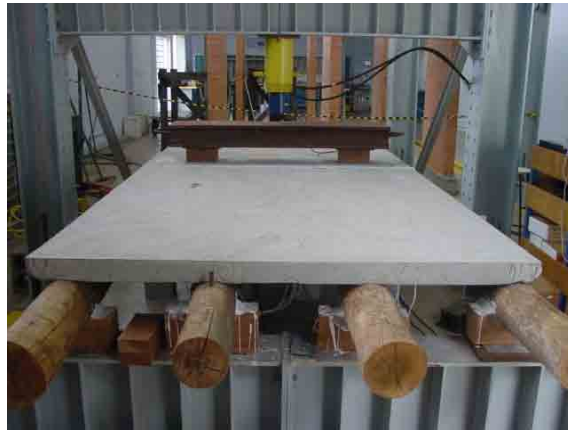
Figura 6.20 – Trem-tipo utilizado no carregamento da ruptura do tabuleiro misto de madeira-concreto
