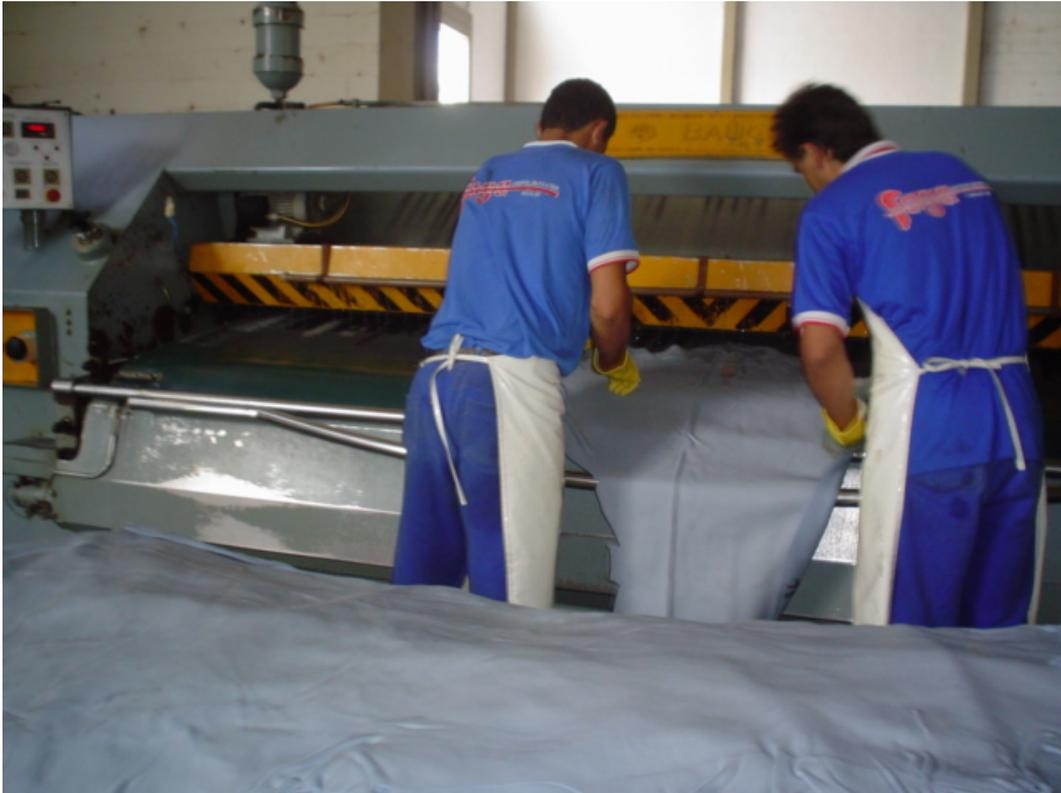
FIGURA 3.6 – Couro passando pela enxugadeira após retirado do fulão de curtimento.
