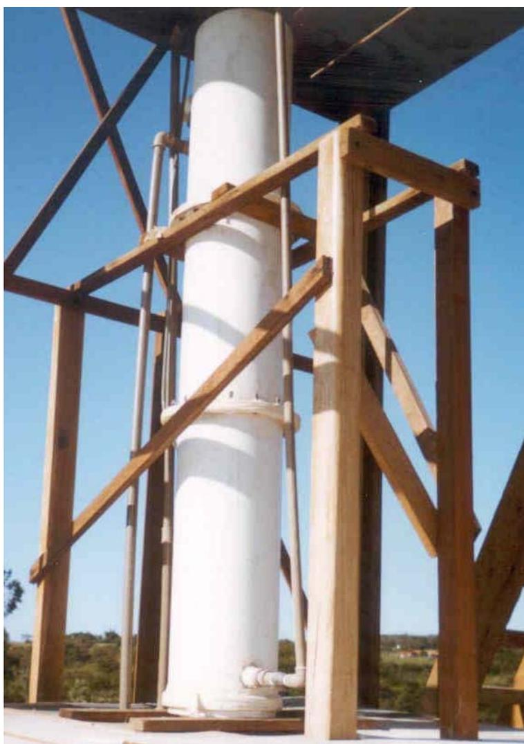
FIGURA 4.7 –Biofilto Aerado Submerso de 300mm de diâmetro
