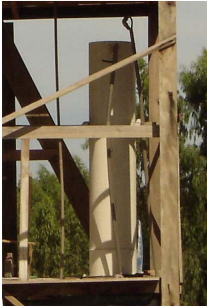
FIGURA 4.9 –Biofilto Aerado Submerso de 400mm de diâmetro
