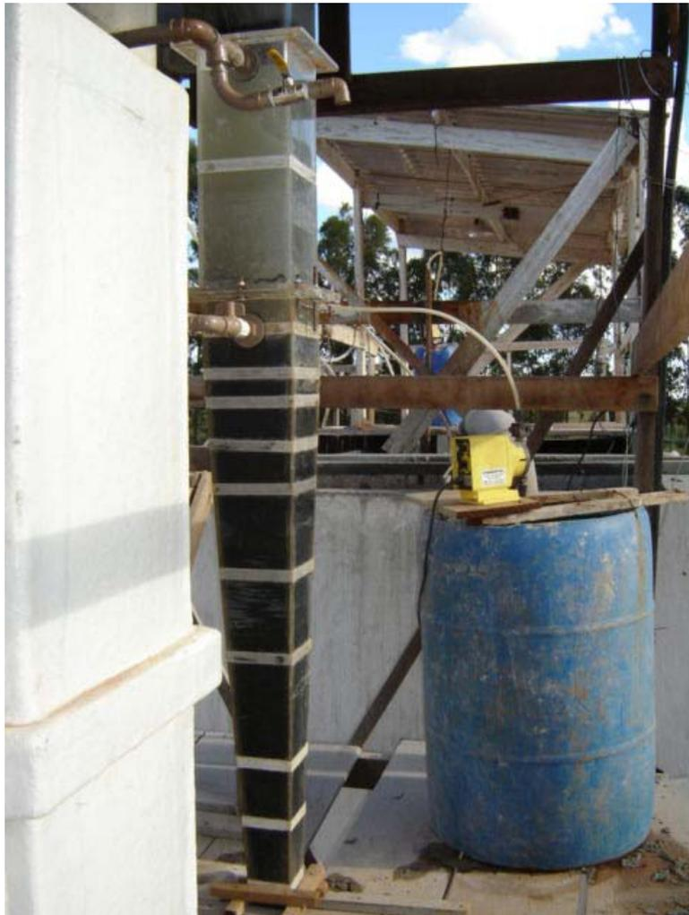
FIGURA 4.6 – Floculador de Manta de Lodo e reservatório de coagulante.
