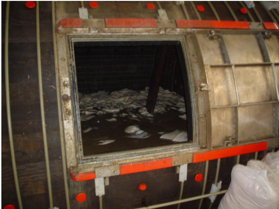
FIGURA 3.3 – Fulão com couro (saída do processo de depilação e caleiro)
