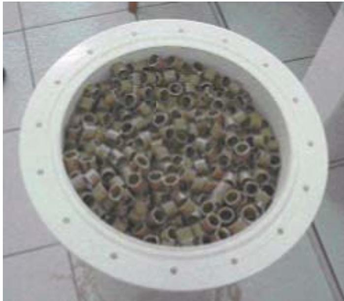
FIGURA 4.8 – Enchimento utilizado como meio suporte para o biofilme
