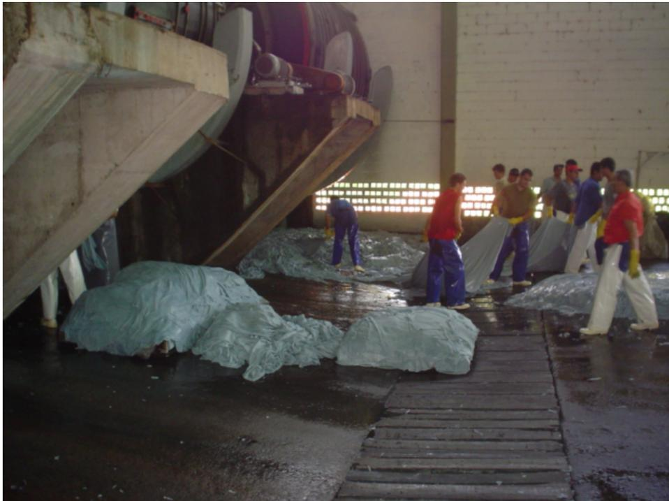
FIGURA 3.5 – Retirada do Couro “wet blue” do Fulão
