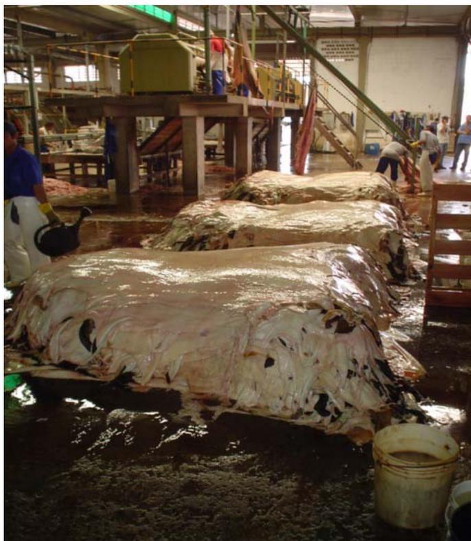
FIGURA 3.2 – Couro hidratado após o processo de remolho
