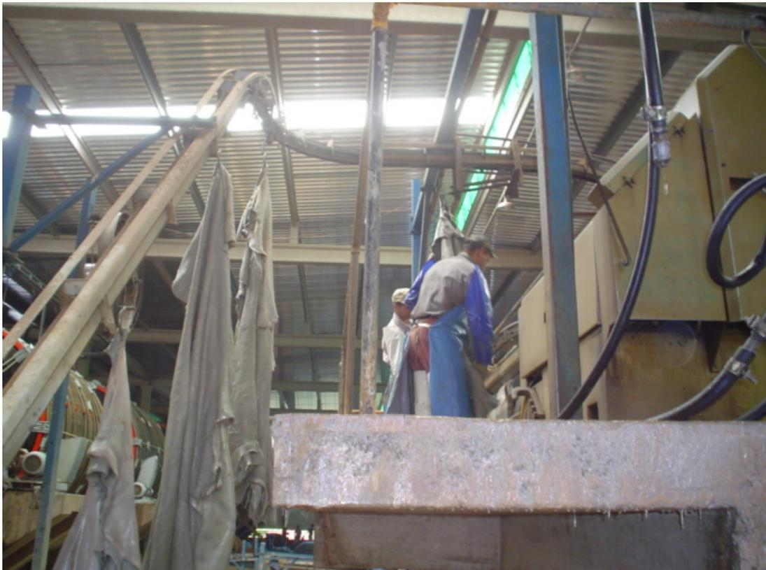
FIGURA 3.4 – Couro depilado seguindo para a máquina divisora
