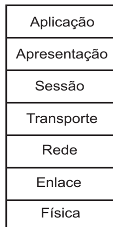
Figura 2.4: Esquema do modelo de referência OSI.
