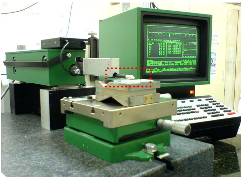
FIGURA 13 - Equipamento utilizado para a leitura da rugosidade superficial ¶
