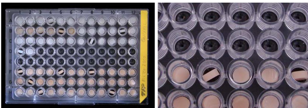
FIGURA 16- Ilustração dos espécimes acondicionados na placa Transwell-96. Observar marcação de colunas e linhas e a disposição dos espécimes
