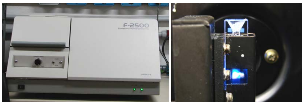
FIGURA 22 - Ilustração do espectrofotômetro de fluorescência (F-2500) e cubeta de quartzo posicionada para análise. Observar o feixe de luz azul passando pela cubeta
