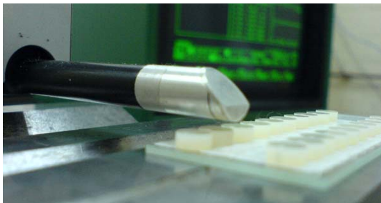
FIGURA 14 - Ilustração da ponteira Focodyn. Observar a distância entre a ponta analisadora e a superfície do espécime
