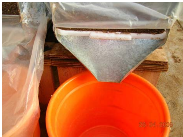
FOTO 1 – FUNIL ADAPTADO À BANDEJA DE EROSÃO.
