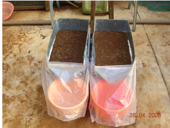
FOTO 6 – APARÊNCIA DAS BANDEJAS DE EROSÃO COM OS BALDES DE COLETA.
