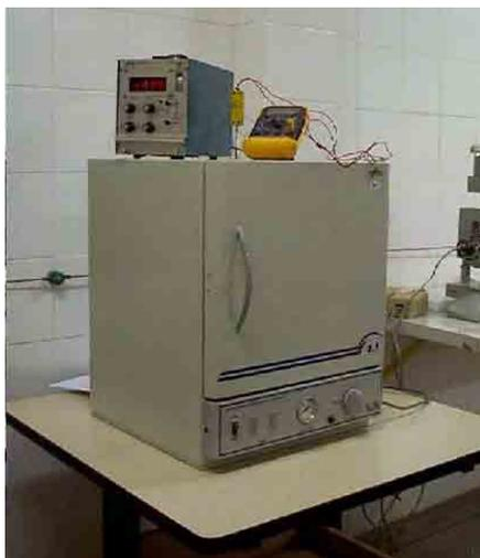
**Figura 10:** Sistema utilizado para medidas de expansão térmica.
