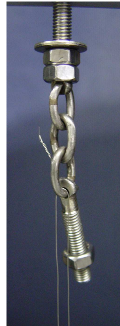
Figura 11 Fixação do fio de amarrilho à célula de carga
