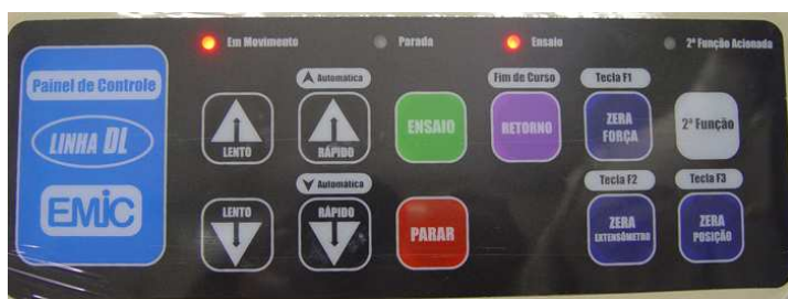
Figura 8 Painel de controle da máquina de ensaio Emic DL2000®
