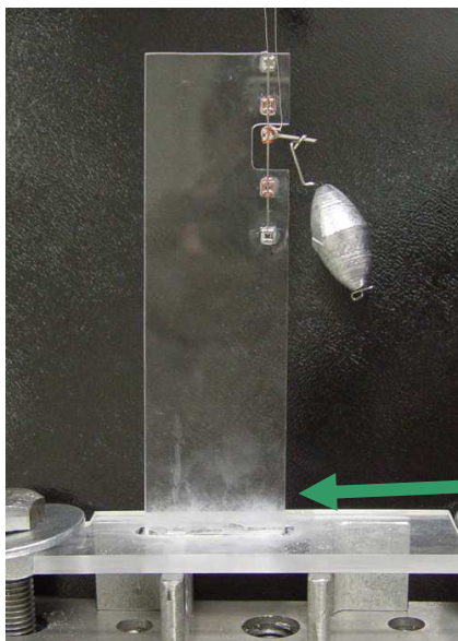
Figura 15 Placa de acrílico posicionada perpendicularmente ao solo e presa a máquina de ensaio EmicDL2000®.
