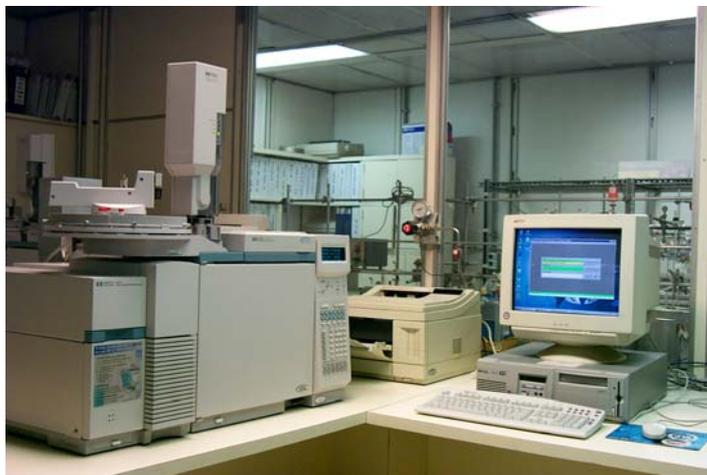
Figura 4.8: Equipamento de cromatografia em fase gasosa acoplado à espectrometria de massas para análise de biomarcadores.
