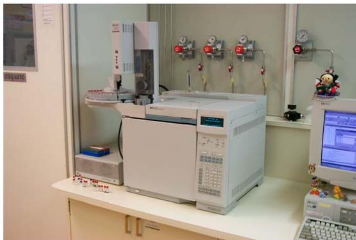
Figura 4.6: Equipamento de cromatografia em fase gasosa utilizado.
