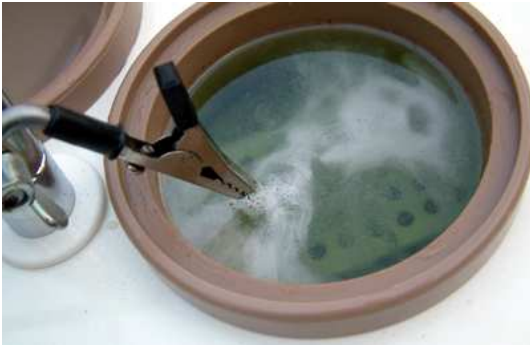
Figura 4 – Corpo de prova imerso no ácido ortofosfórico 75%
