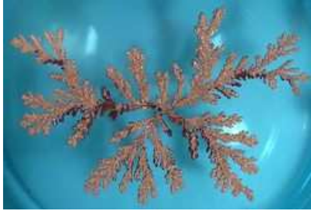
Figura 2.1: Estrutura gerada por meio do modelo de DLA, a partir de uma solução de sulfato de cobre em uma célula de eletrodeposição.
