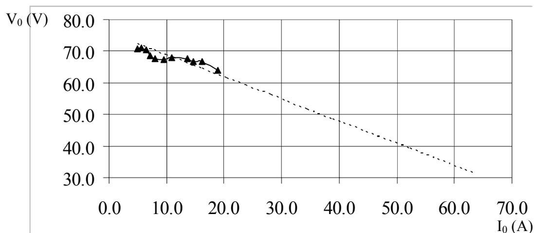
Figura 5.17: Característica estática de saída emulada pelo conversor alimentado com  $V_{in} = 400V_{CC}$ .
