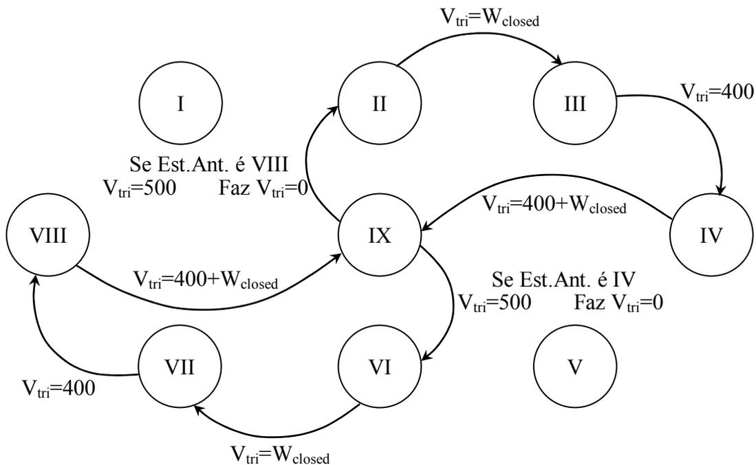
Figura 4.9: Máquina de Moore da condição explicitada pela Figura 4.8.
