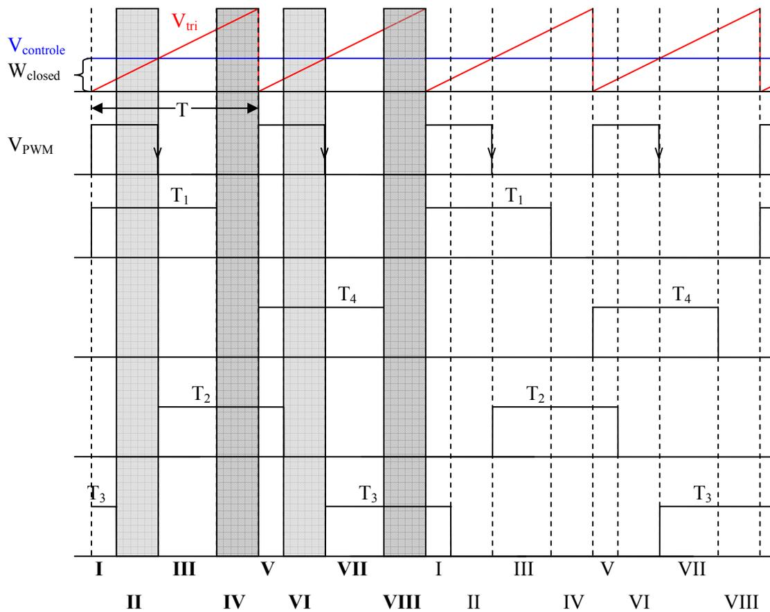
Figura 4.4: Diagrama de lógica de chaveamento para defasagens medianas
