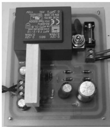
Figura 5.11: Fonte simétrica para alimentação dos filtros ativos.
