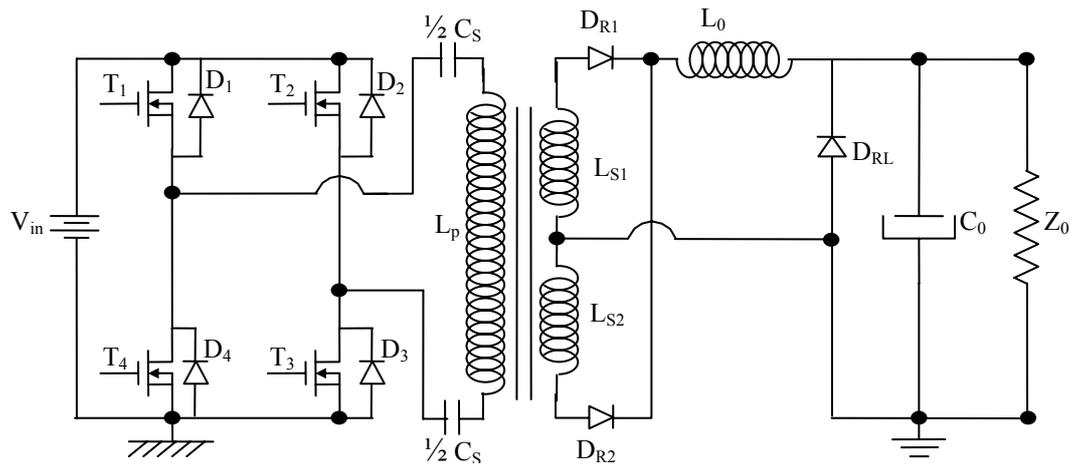
Figura 5.5: Conversor “*Buck-Full-Bridge*” isolado com sensores de tensão e corrente.
