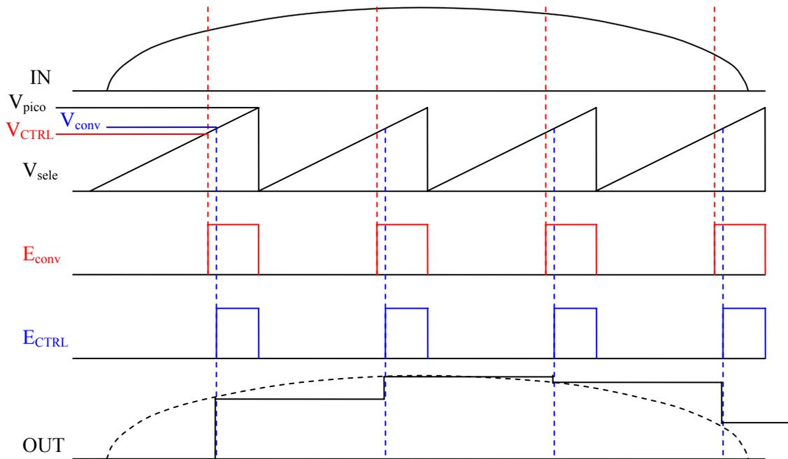
Figura 3.5: Funcionamento do bloco de memória no PSpice.
