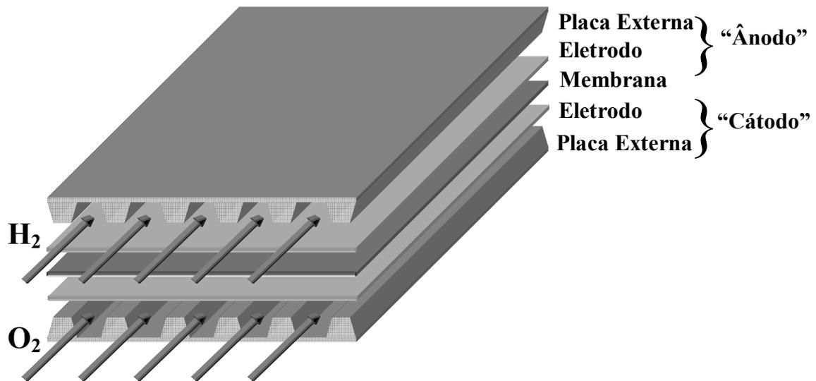
Figura 1.3: Constituição básica de uma célula combustível.
