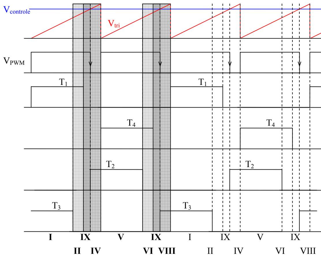
Figura 4.6: Diagrama de lógica de chaveamento para defasagens elevadas ( $W_{\text{closed}} > 400$ ).
