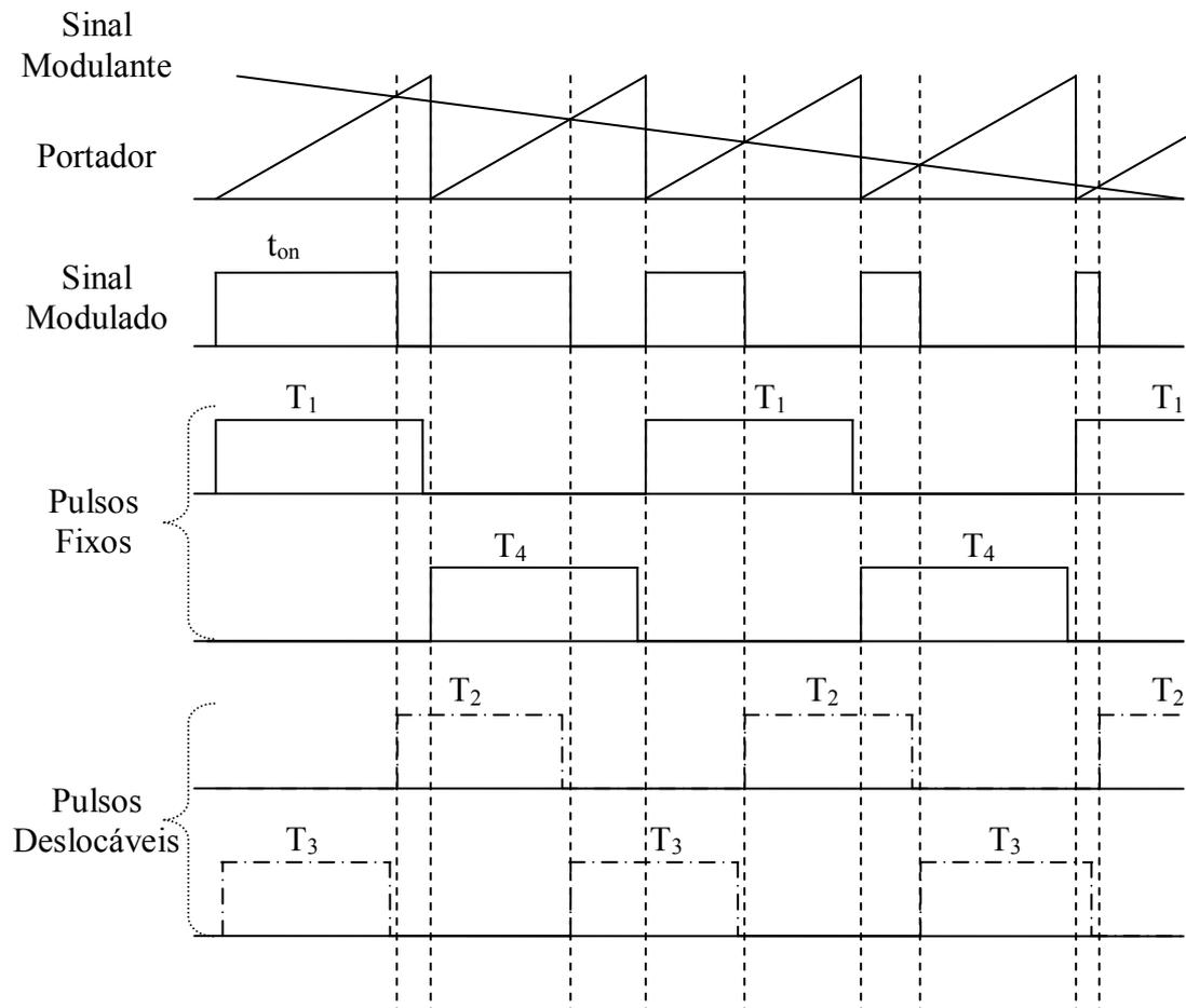
Figura 2.14: Geração de “*PWM-Phase-Shift*”.
