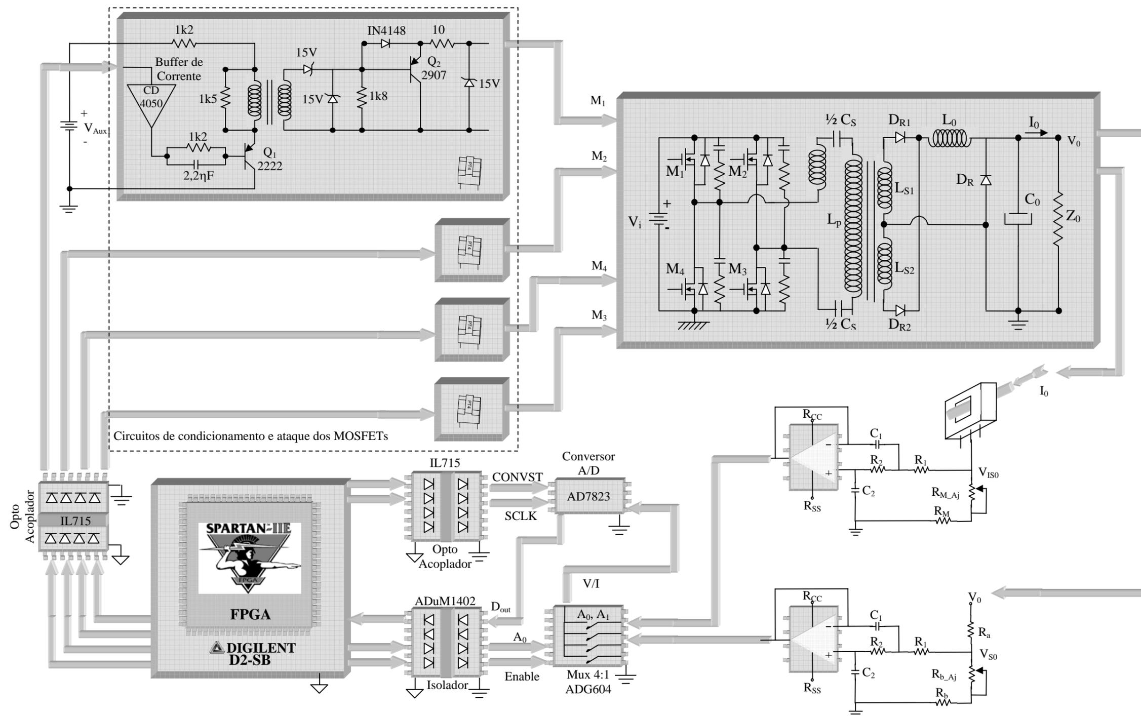
Figura 6.1: Diagrama com o circuito completo do emulador de célula combustível controlado por FPGA.
