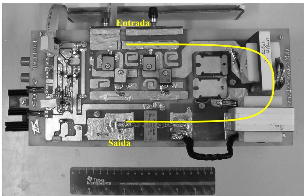
Figura 5.6: Visão superior do circuito de potência.
