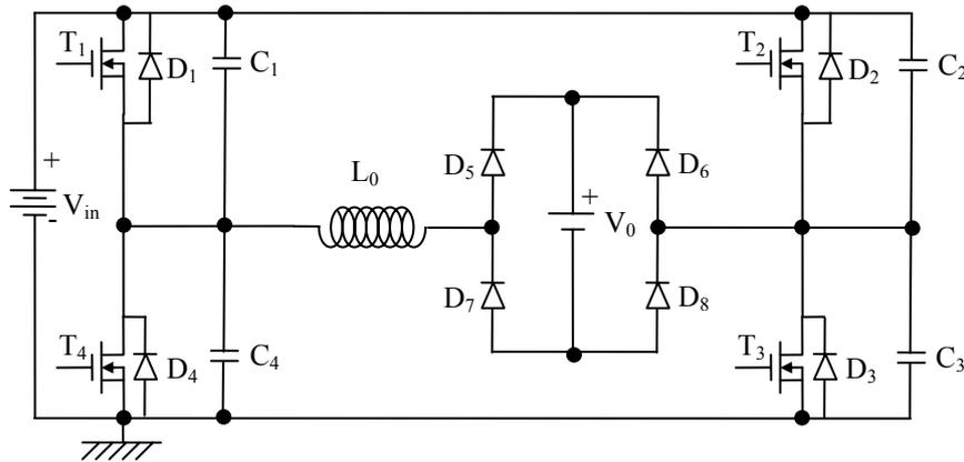
Figura 2.3: Circuito Simplificado do conversor “Buck-Full-Bridge” referido ao primário do transformador de isolação.
