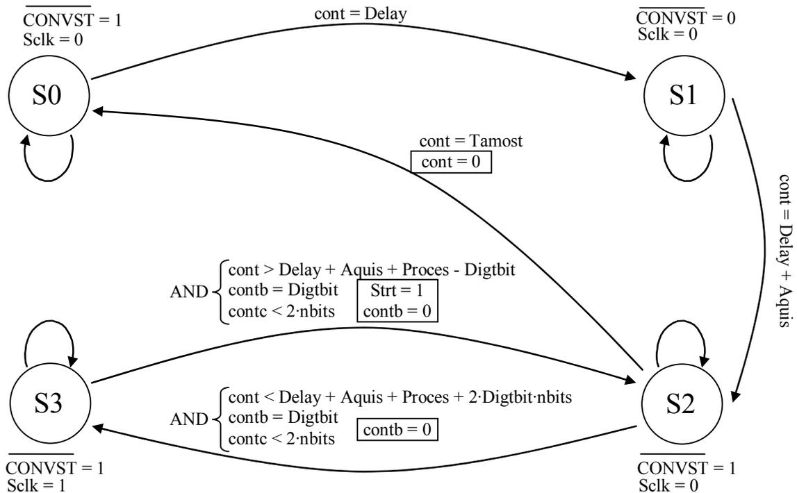
Figura 4.2: Máquina de Estados para a lógica de controle e do conversor A/D “AD7823”.
