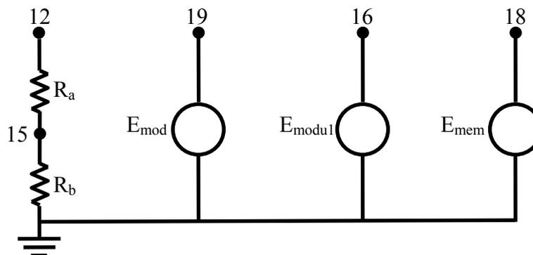
Figura 3.3: Sensor de tensão e as fontes de tensão controladas por tensão para efetuar comparações, possibilitando assim a obtenção da lógica do controle digital.
