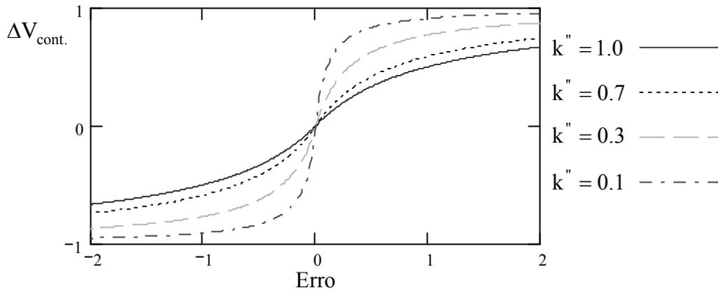
Figura 2.18: Avaliação de  $\Delta V_{cont.}$  em relação à variação do erro para diferentes valores da constante  $k''$ .
