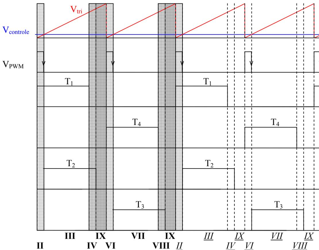
Figura 4.8: Diagrama de lógica de chaveamento para defasagens diminutas ( $W_{closed} < 100$ ).
