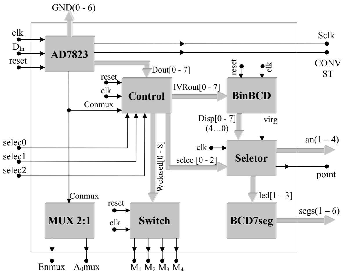
Figura 4.1: Diagrama de bloco da descrição de hardware VHDL implementado no dispositivo FPGA SPARTAN XC2S200E.
