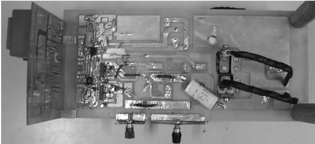
Figura 5.7: Visão inferior do circuito de potência.
