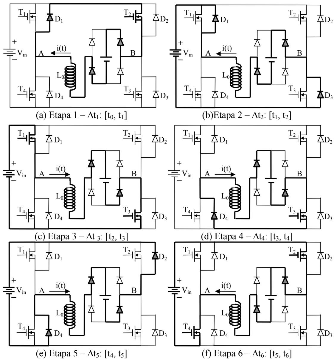
Figura 2.4: Etapas de funcionamento do conversor “Buck Full-Bridge” (circuito simplificado).
