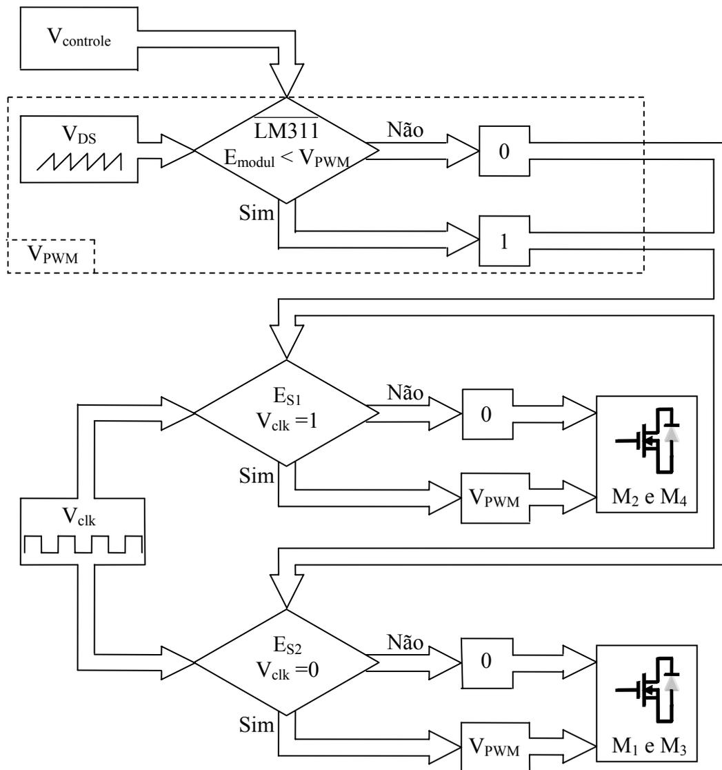
Figura 3.10: Fluxograma do sistema de modulação PWM.
