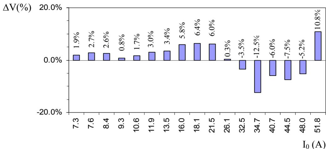
Figura 5.16: Erro percentual das tensões entre a curva idealizada e a obtida experimentalmente.
