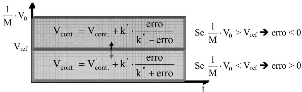
Figura 2.17: Posição das equações de controle com relação a  $V_{\text{ref}}$  e  $\frac{1}{M} \cdot V_0$ .
