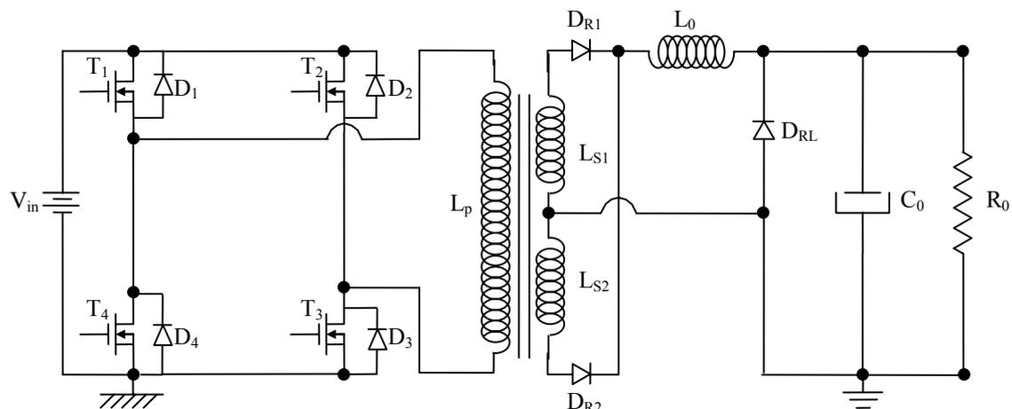
Figura 2.2: Conversor “Buck-Full-Bridge” isolado.
