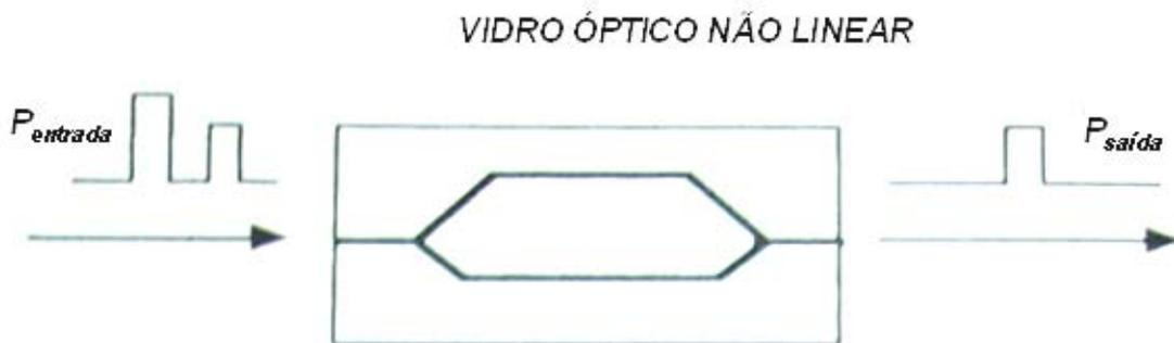
Figura I. 3: Seletor de pulso interferométrico Mach-Zender
