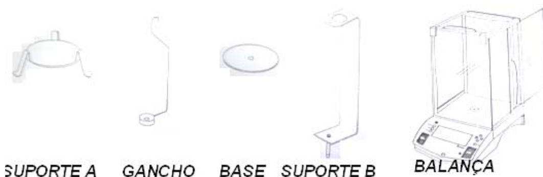
**Figura 3.3. 1: Equipamentos utilizados para medição da densidade.**
