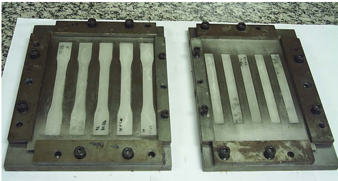
Figura 17. Fotos dos moldes usados na preparação dos corpos de prova.
