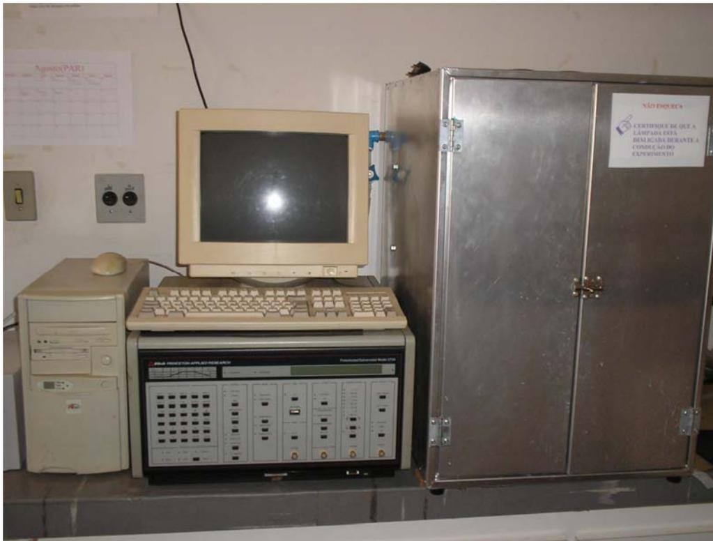
**Figura 13.** Potenciostato/galvanostato PAR modelo 273A.
