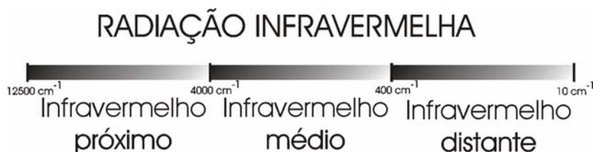
Figura 12: As três partes da radiação de infravermelho.
