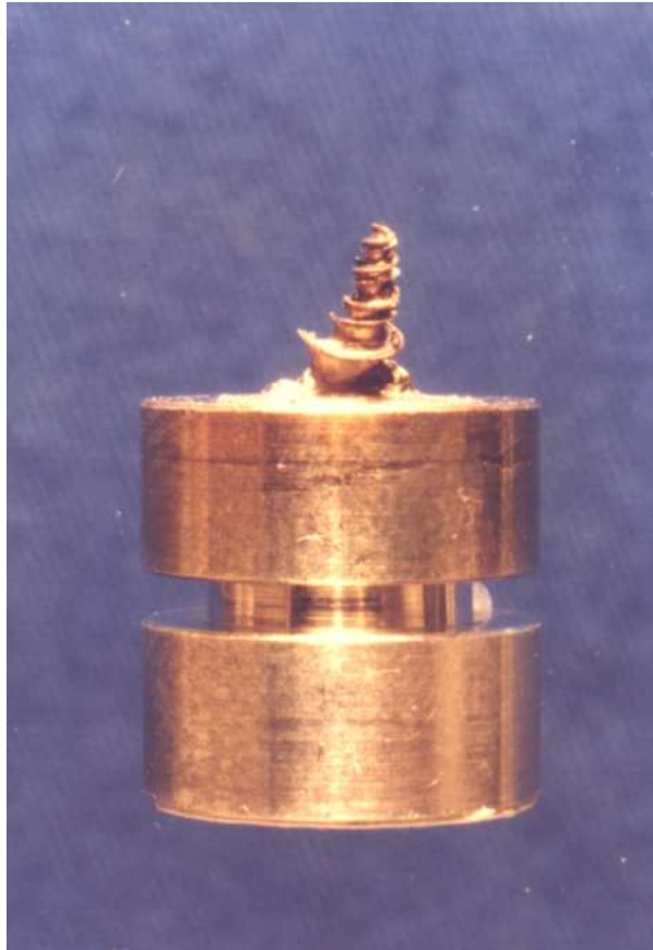
Figura 3 Porta-espécime mostrando cóclea preparada para estudo em microscópio eletrônico
