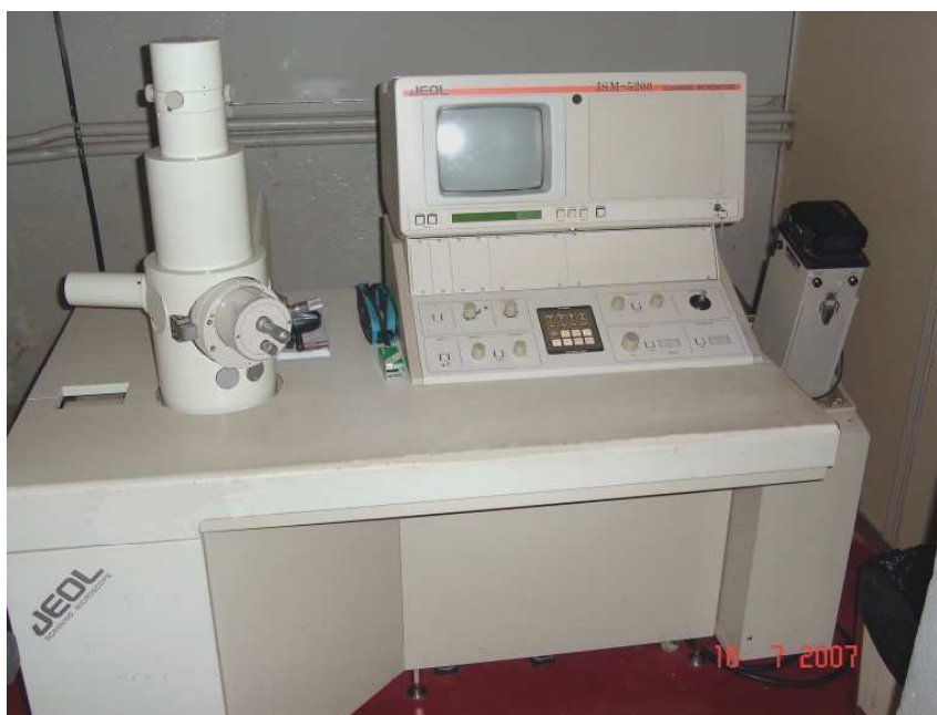
Figura 4 Microscópio Eletrônico Jeol Scanning Microscope – JSM 5200
